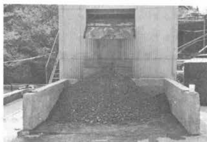
写真-2 脱水ケーキの状況
