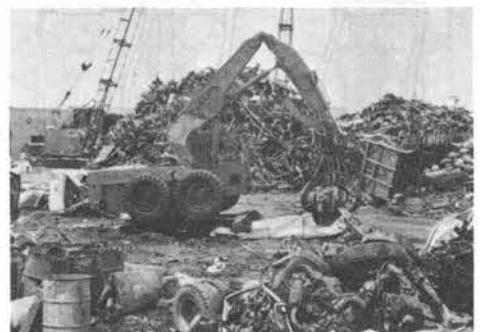
写真-2. エンジン部分の引きちぎ
