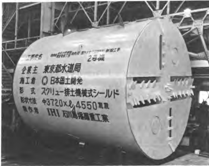
写真-2 土圧(スクリュー排土)式シールド機(前面)
