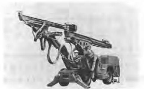
写真-2 油圧モービルジャンボ（三井&フランスセコマ社）
