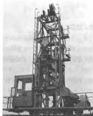
写-2 TST表面固化处理機 (走行台車)
