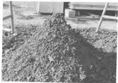
図.4 脱水ケーキ堆積状態
