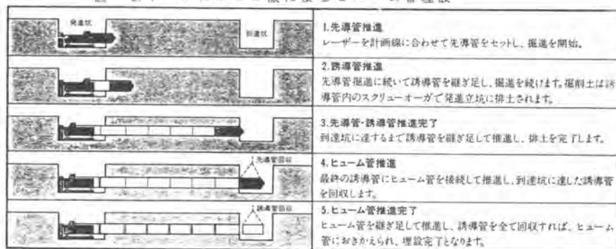
図-2.1 SMOLE機によるヒューム管埋設
