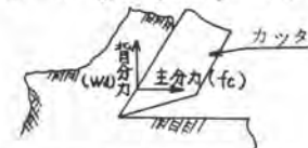
図-4 カッタに作用する背分力と主分力
