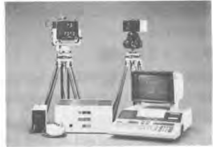
写真-1. 作業船位置決め測量装置
