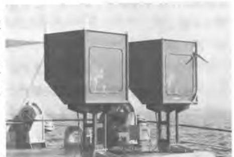
写真-3. 自動視準光波距離計の取付状況
