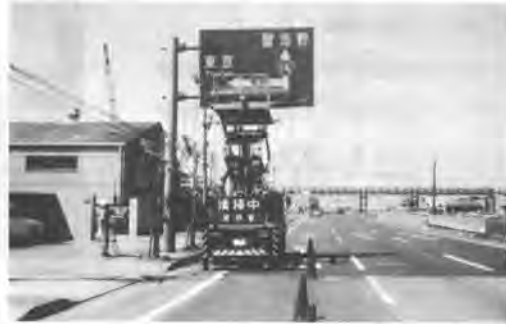
写真-1 標識板清掃車
