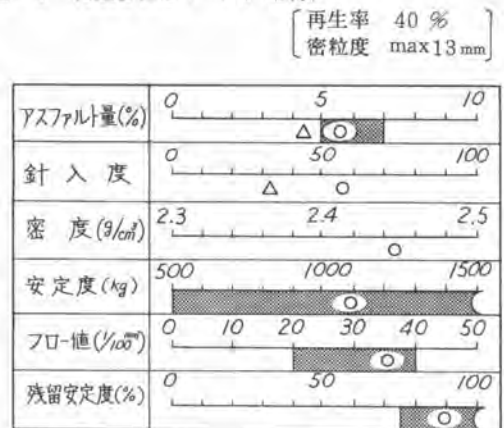
図-5 再生合材のマーシャル試験
