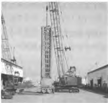
クローラークレーンをベースマシンとしたハイドロフレーズ
