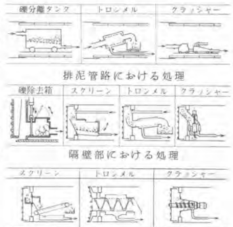
シールド機内における処理
