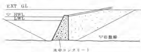
第1図 水中コンクリート方式
