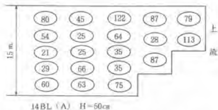
図-5 コンクリート放出時間(従来施工)
