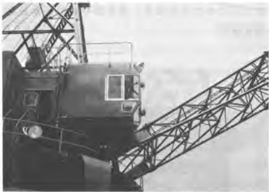
写真-2 運転室 (作業性をよくするため視界、照明および騒音隔離に配慮)
