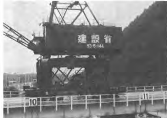
写真-3 電源用と衝突防止装置2個のケーブル巻取機を装備
