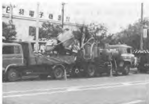
写真-1 側溝清掃車(脱水処理装置付)概観
