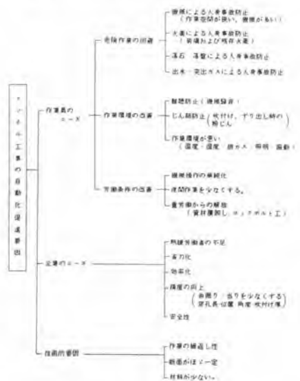
図-1 トンネル工事の自動化促進要因
