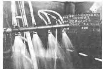
写真-4 D_2 ノズルの噴射状況
