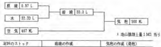
図-1 気泡の作成過程と材料配合例
