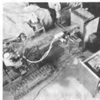
写真-2 クローラ式ノズル装着装置
