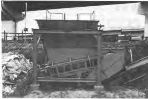
写真-1 塵埃土砂供給装置
