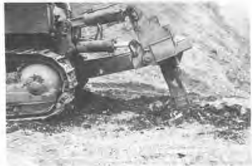
写真1 掘削力測定中のブルドーザ
