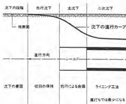
図-2 沈下の進行モデル
