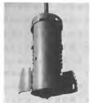
写真-4 下部拡底ビット拡翼
