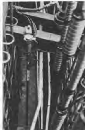
写真3. ヨークに取付けられた温度センサー
