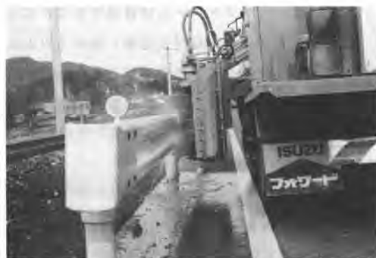
写真-2 清掃試験状況
