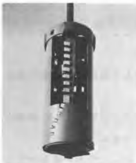
写真-2 拡底ビット閉翼
