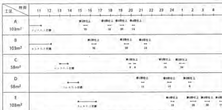
図—4.2 (A)作業所施工サイクルタイム
