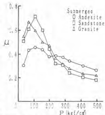
図6 種々の岩石に対する摩擦係数 \mu と接触面圧Pの関係(水浸状態)
