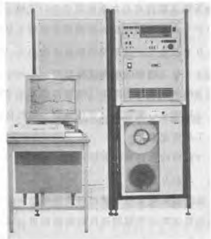
写真-3 ひびわれ一次処理装置
