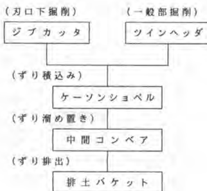
図-2 土丹掘削時の使用機械
