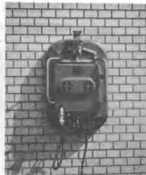
写真-5 外壁タイル剝離 調査ロボット
