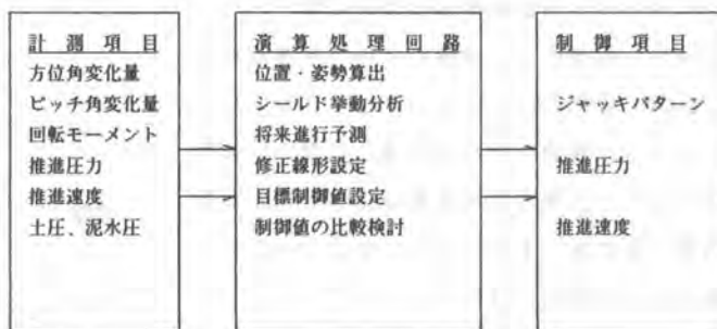
図-5 方向制御ブロック図
