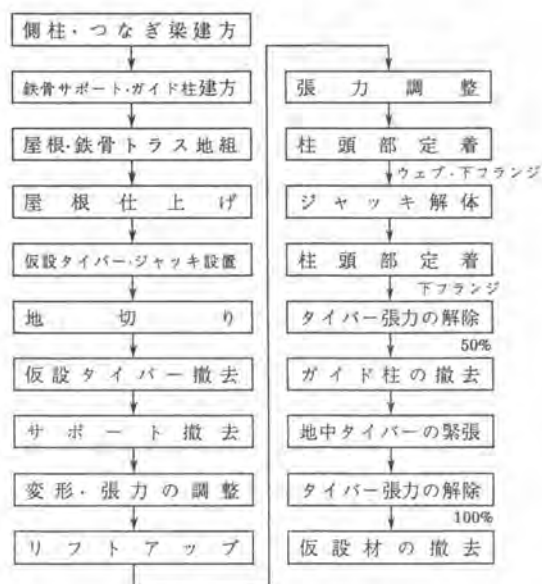
図-2 施工フロー
