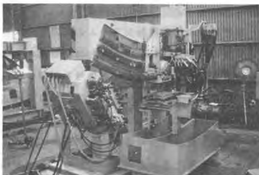
写真5 ボルト・ナット供給締結試作装置
