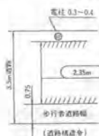
図2. 道路幅 3.5mでの工事想定図
