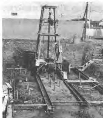
写真-3 実験用処理機(攪拌翼ピンタイプ)
