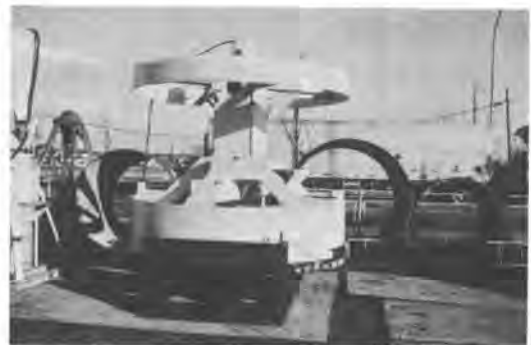
写真-1 軸部掘削用油圧閉式両開きバケット
