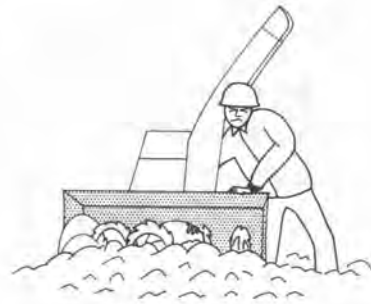
図-2 事故の事例（雪づまり除去時に除雪装置に手を入れ負傷）
