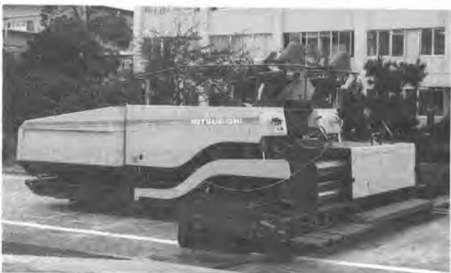
写真2 MF60B全油圧駆動クローラ式
