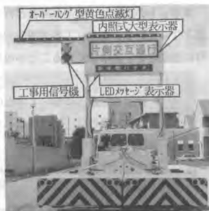
写真－3 工事情報表示装置全景
