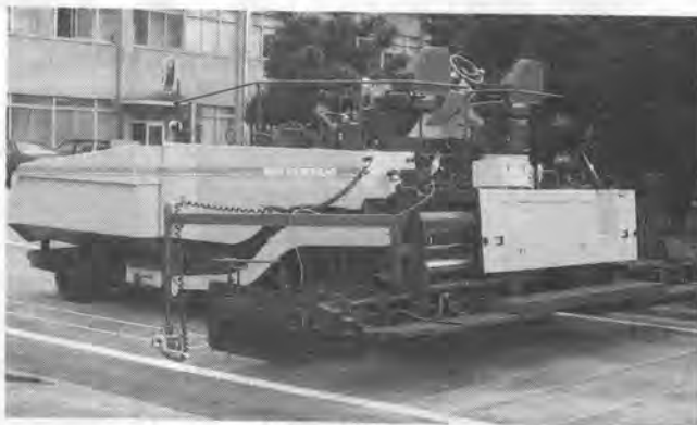
写真1 MF60WB全油圧4輪駆動ホイール式 <M600スクリッド (MAX6m)>
