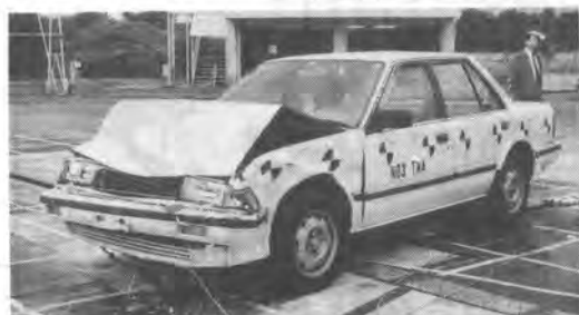
写真-10 突入後の試験車両損傷状況
