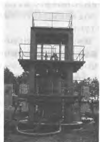
写真-4 鉛直掘削実験装置
