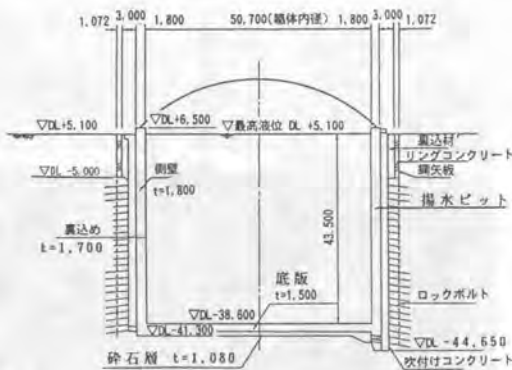
図-1 地下タンクの構造(断面)
