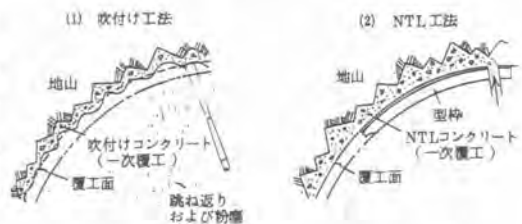
図-1 吹付け工法とNTL工法
