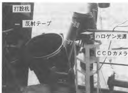
写真-2 CCDカメラ設置状況
