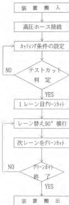
図-4 水ジェットタイプ施工手順
