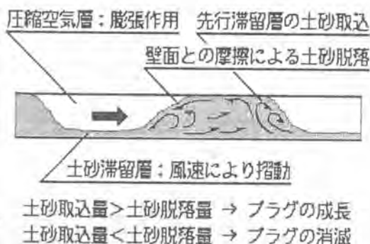
図-3 混気圧送（プラグ流）のメカニズム
