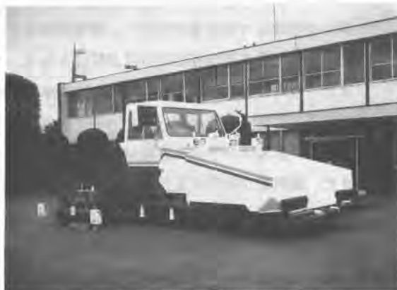
写真-1 ロッドアスファルトフィニッシュ全景
