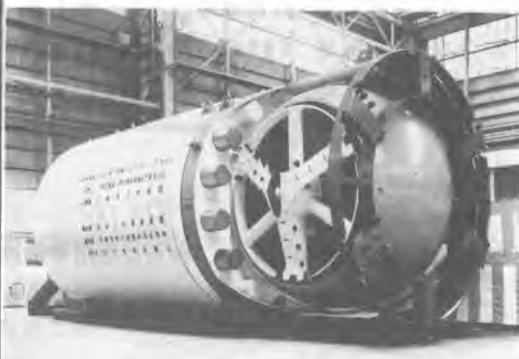
写真-2 直角シールド
