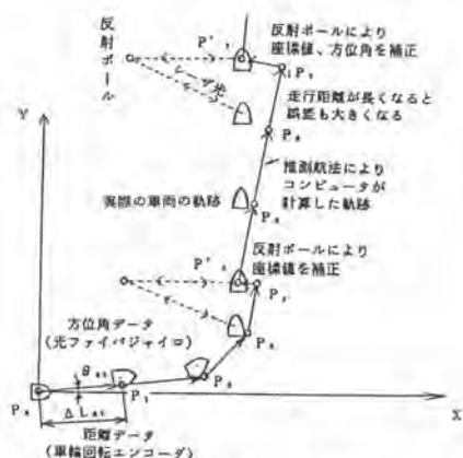
図-6 位置計測補正原理
