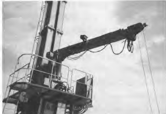
写真-3 ブームに設置した立体視カメラ
