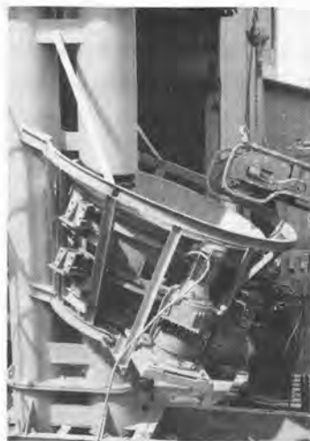
写真1 回転土砂ホッパー
