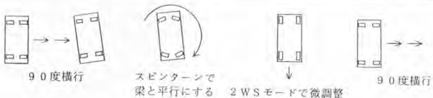
図-6 自律走行台車の自己位置補正
