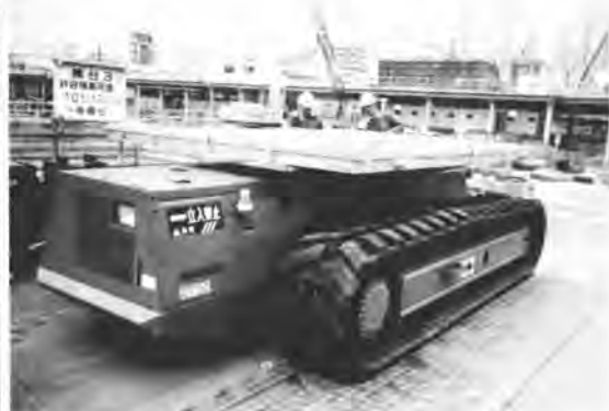
写真1 低床式重量物運搬機の外観
