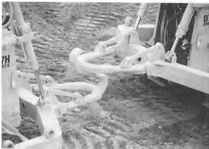
写真-2 非常時脱出装置
