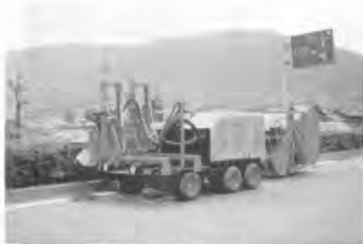
写真-3 自走式自動剪定機
