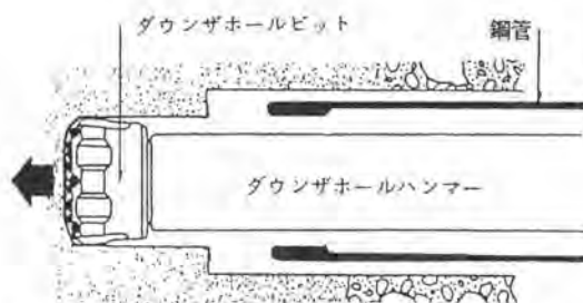
図-7 ダウンザホールビットによる先行削孔
