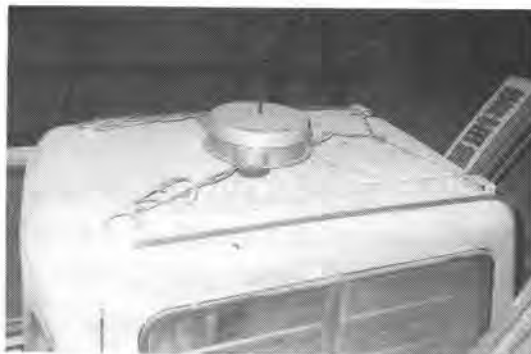
写真-2 バックホーへの親機の取付け (丸子トンネル作業所にて)
