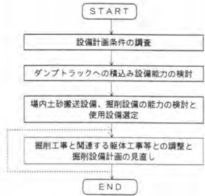
図5 掘削土搬出設備の計画手順
