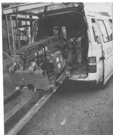
ワンボックスカーへの昇降 (現場間移動 ：ワンボックスカー使用)
