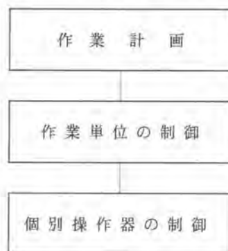
図-1ブルドーザの制御システムの構成
