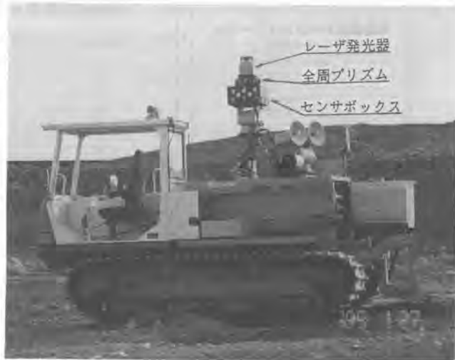
写真-1 遠隔操作カメラ車部
