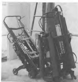
分割状態 ：クレーン部、 階段昇降台車部
