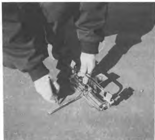
写真-4 手動型墨出し用位置決め装置
