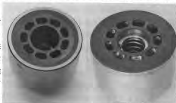
写真1 高圧ピストンポンプ試験後のシリンダーの状態
