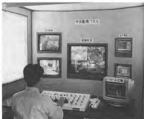
写真-3 地上遠隔操作状況
