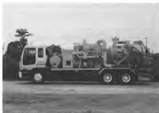
写真1 排水性舗装機能回復車
