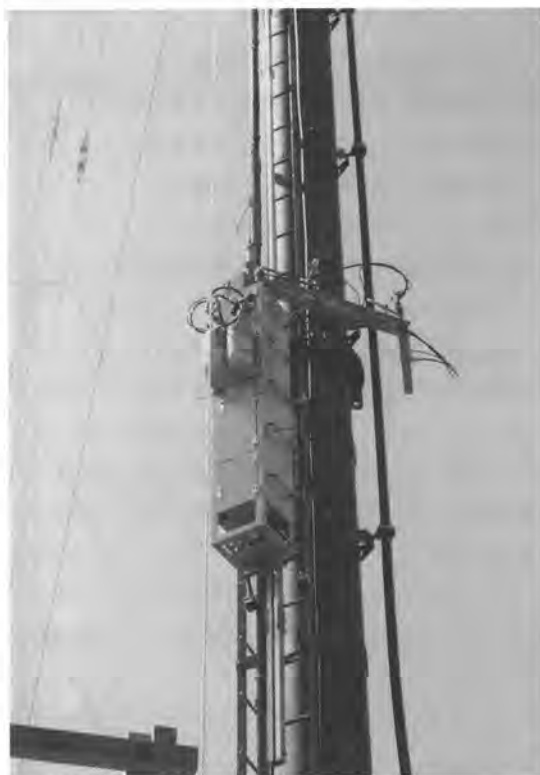
写真1 塗装ロボット
