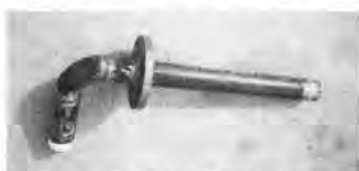
写真 3-3 パイプシャワーシステム ノズルパイプ
