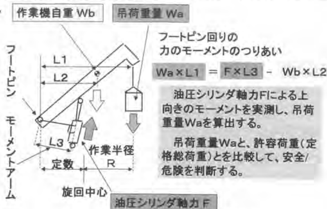
図-1 過負荷防止装置の基本原理
