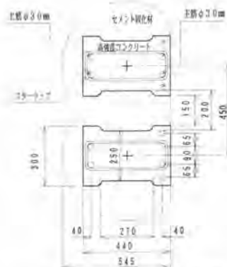
図-11 仮壁部材詳細図
