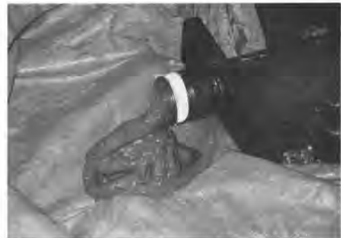
写真-2 6時間冷却後の注入材の排出状況
