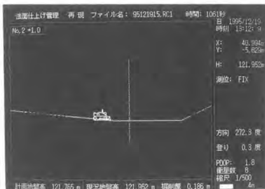
写真-5 法面仕上げ管理モニター画面
