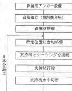
図-4 鋼管杭打設フロー
