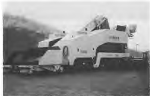
写真-1 マルチアスファルトペーバの外観
