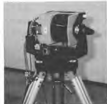
写真-1 断面測定機と三脚架台
