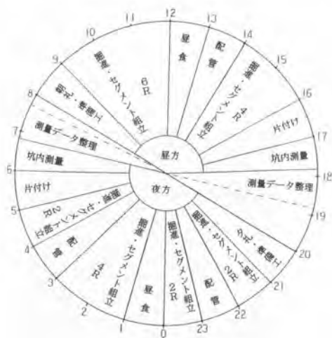
図-6 同時施工サイクルタイム
