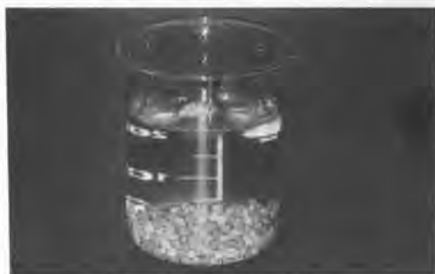
図-7 再泥化の状況
