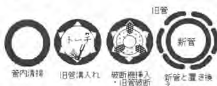
図-2 プラズマモール工法概念図
