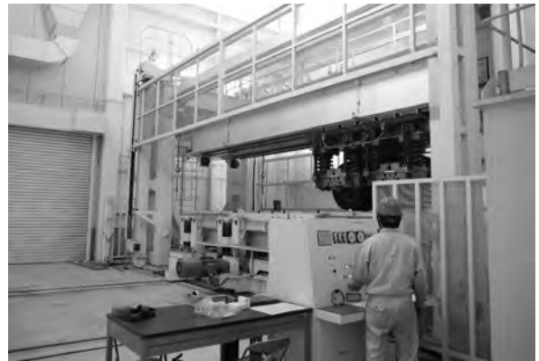
図-11 輪荷重載荷試験機
