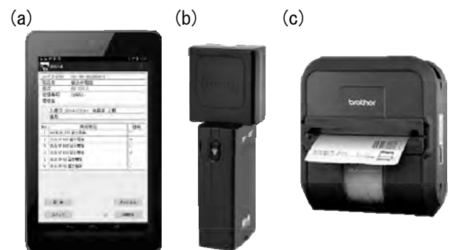
図-5 システムで使用する携帯端末。(a) タブレット (Google 社製 Nexus7), (b) タグリーダー (D.O.TEL 社製 DOTR-910J), (c) ラベルプリンター (ブラザー社製 RJ-4030)。
