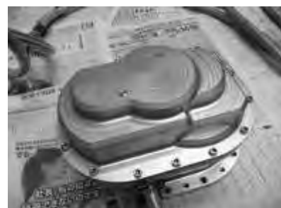
写真-7 ロータリーアクチュエータ (クローラ)
