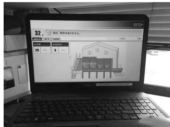
写真-11 危険エリア侵入監視システム表示画面
