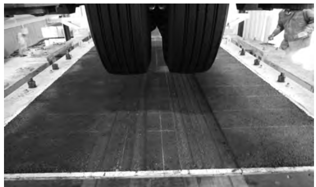
図-14 沈下状況(2.8万回載荷後)
