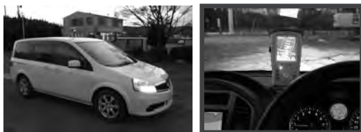
図-3 車両によるGNSS連続測量機材
