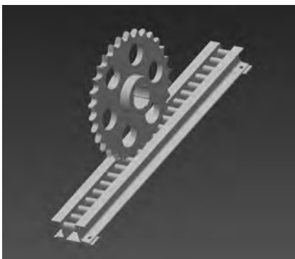
図-2 第3軌条（ラック式レール）
