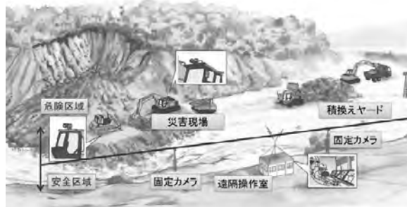
図-1 無人化施工イメージ
