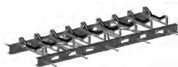
図-5 桁形式のフレーム
