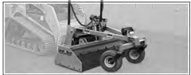
写真-4 自動制御機構を備えたアタッチメント例 (ATI社 LevelBest LASER GRADING BOX 2 )
