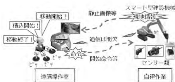
図-2 次世代無人化施工システム
