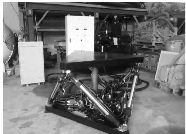
写真-1 モーションベースプロトタイプ（左端より制御装置、モーションベース、油圧ユニット）
