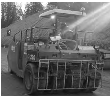
写真-5 バンパー付きタイヤローラへの装着状況
