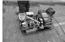
左：ダイヤフラムポンプ、右：コンプレッサー
