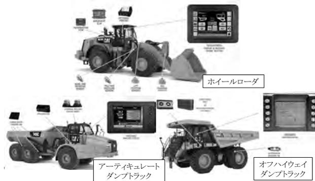
図-3 ペイロード計測システムを搭載した建機の場合
