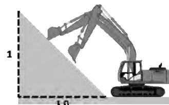
図-8 施工目標面の一例
