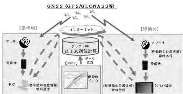
図-1 機器構成と通信イメージ
