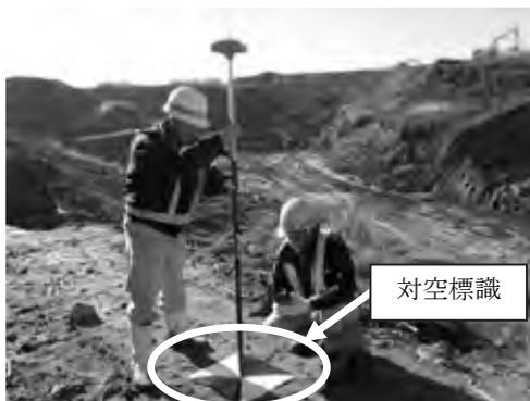
図-9 対空標識の GNSS 測量状況
