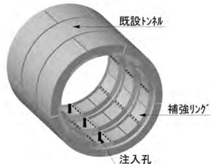
図-2 補強リング配置模式図
