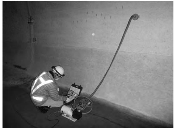
写真-7 透気性試験状況
