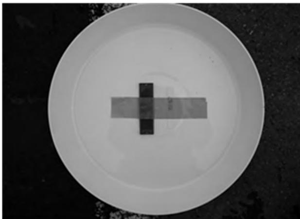
写真-2 ケース内へのICタグ取付状況
