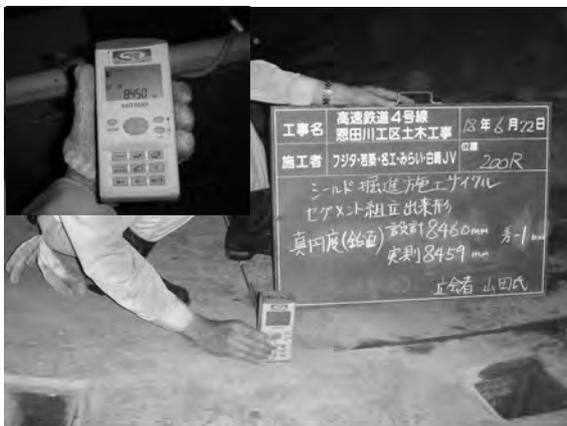
図-3 従来の真円度計測状況
