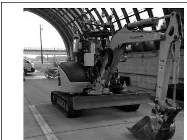
モニタリング装置・無線を搭載した遠隔操作車両
