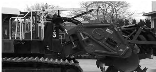
写真-7 後方カメラ格納時
