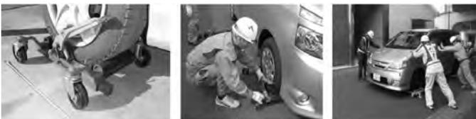
写真-4 車両移動用ジャッキでの乗用車の移動作業
