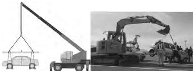
写真-5 クレーン装置による乗用車の吊り上げ作業
