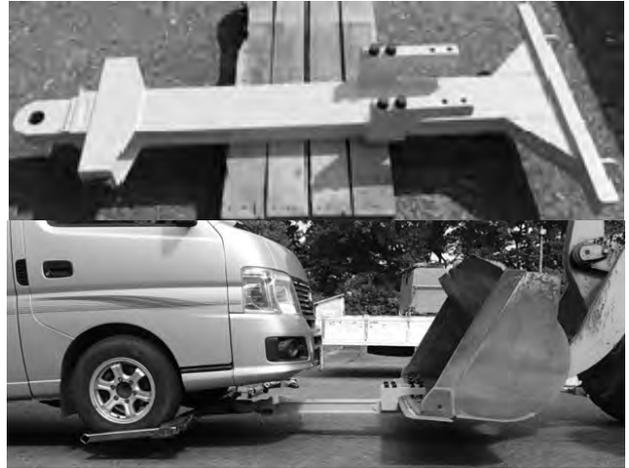
写真-7 ホイールローダ用車両移動機材
