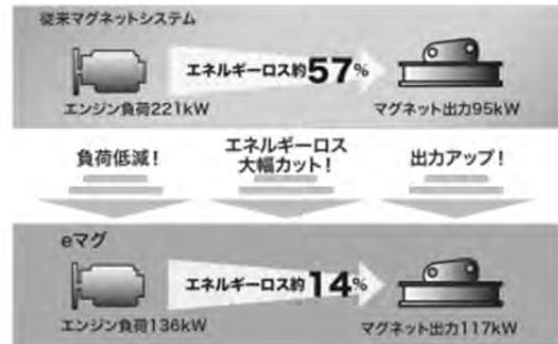
図-5. 電力変換効率
