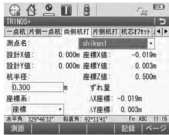
図-4 「杭打計測」計測結果画面
