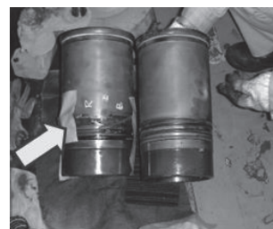
図-3 クレビスシール破損状況
