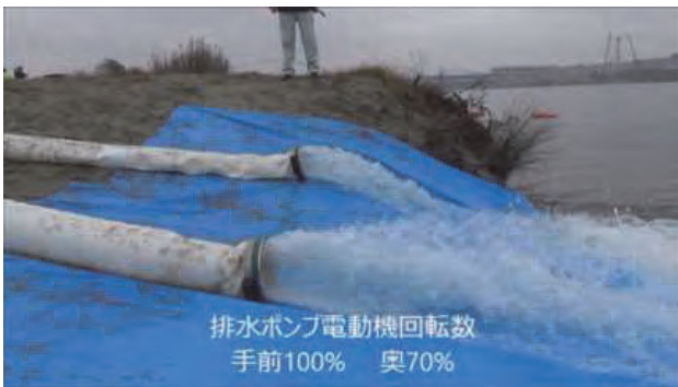
写真-5 排水量低下確認の試験状況
