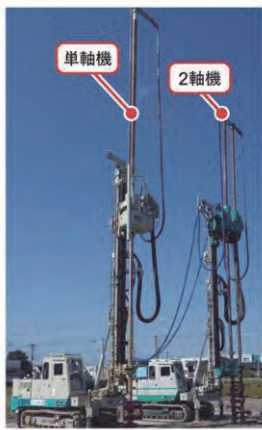
図一4 施工機のタイプと適用範囲
