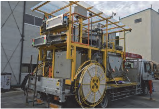
図-3 4連装爆薬遠隔装填システム
