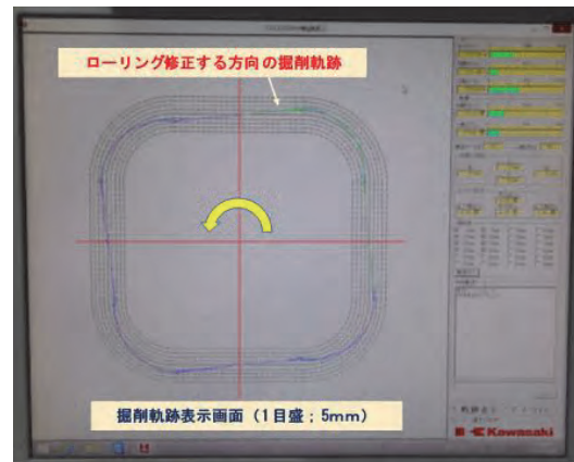
写真-4 ローリング修正掘削システム
