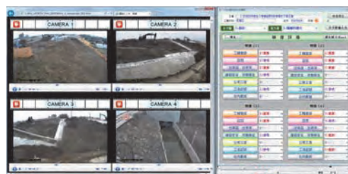
図16 施工データのタグ付け
