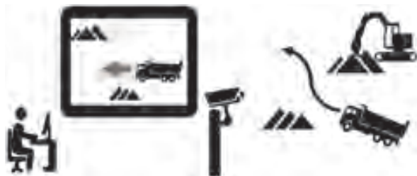
図-1 無人化施工システム
