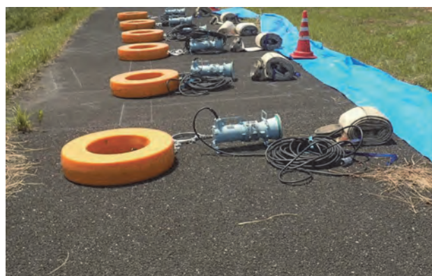
写真-1 排水ポンプ車に搭載している排水ポンプ
