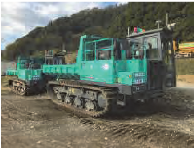
写真-1 自動走行対応型不整地運搬車
