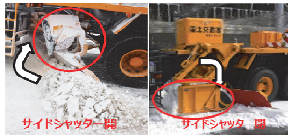
写真-6 サイドシャッターの動作状況
