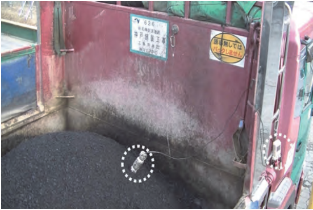
写真-7 Wi-Fi 温度ロガー設置状況
