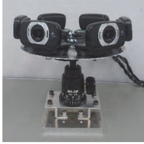
図-1 複数台の Web カメラによる全周囲撮像システム
