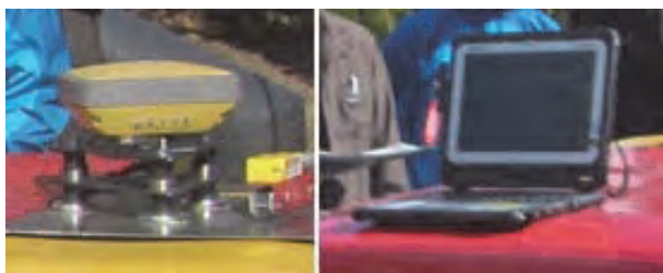
写真-2 締固め管理システム(左:GNSS受信機 右:システム用PC)
