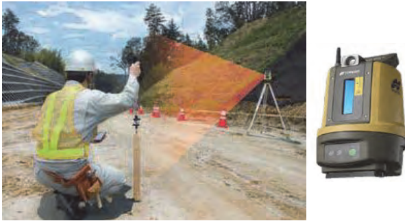
図-7 望遠鏡が搭載されていない TS
