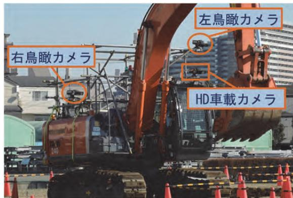
写真-2 カメラ設置状況（鳥瞰映像）
