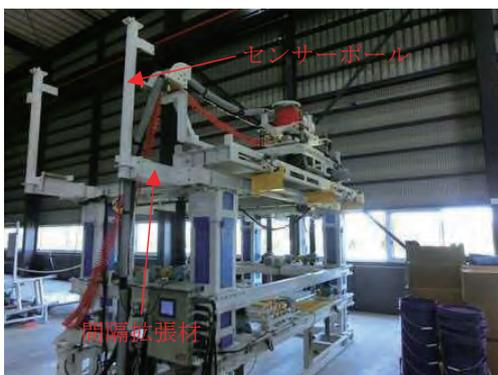
写真-15 改良後接触センサーポール
