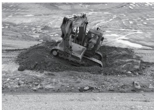
写真-2 重機 LS 傾斜時の計測試験
