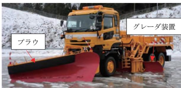
写真-5 除雪トラックの作業装置
