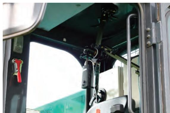
写真-8 360度カメラの取り付け
