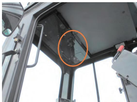
写真-5 360度カメラの取り付け
