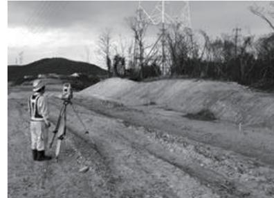
写真-3 地上型 LS の計測状況
