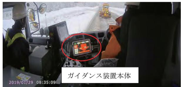
写真-7 ガイダンス装置本体車載例
