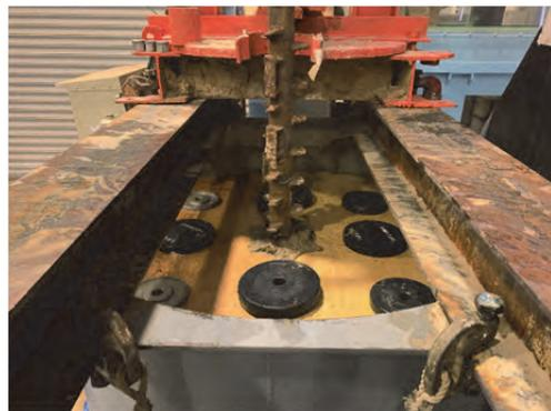
写真-4 上載圧を加えた室内模型実験
