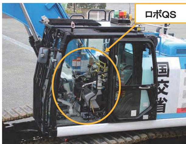
ロボQSが対応する現場は、法面崩壊など二次災害の恐れがあり有人施工が困難な場所で、災害発生直後の応急復旧作業において主に使用されている。このような現場では、倒木や巨石等が大量に発生している場合もあり、バックホウのバケットでの除去作業では作業効率が劣る。そのため、今回ロボQSのバケット操作機能に加えて、つかみ機やブレーカーなどのアタッチメント操作機能を追加し、災害初動時における装置の高度化を図ったので紹介する。
