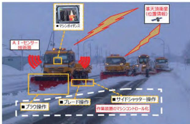
写真-9 除雪トラックMC化イメージ
