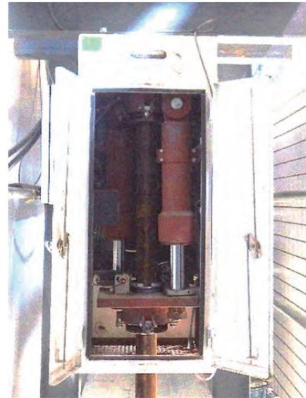
写真-3 昇降ロボットジャッキ
