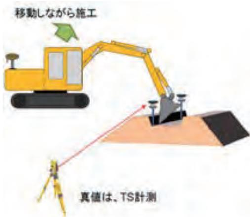
図-5 整形作業での精度検証方法
