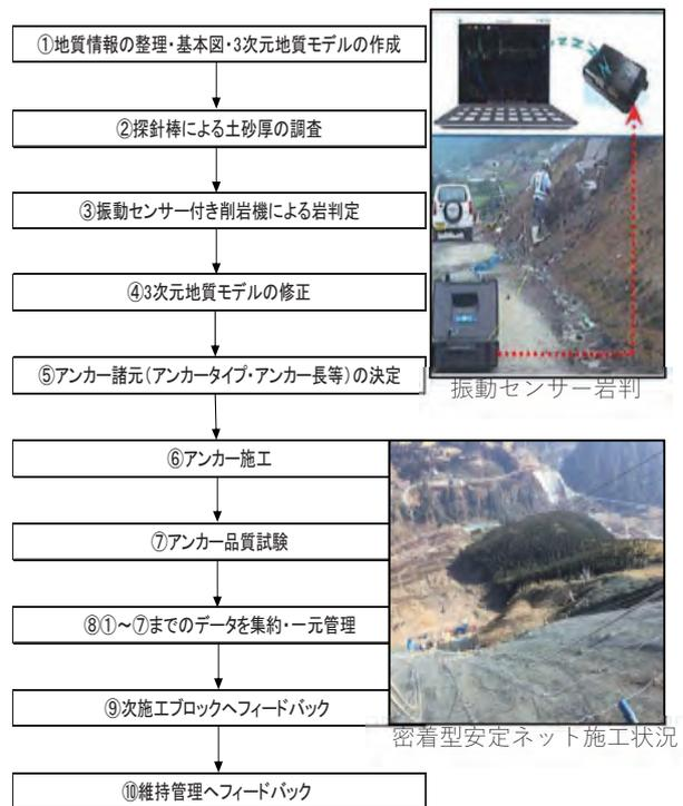
図-9 のり面 CIM 施工フロー図
