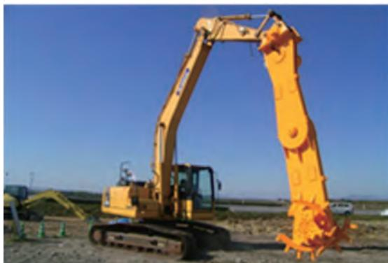
写真-1 WILL 工法施工機
