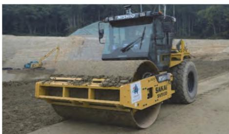
図-1 自立制御型振動ローラ
