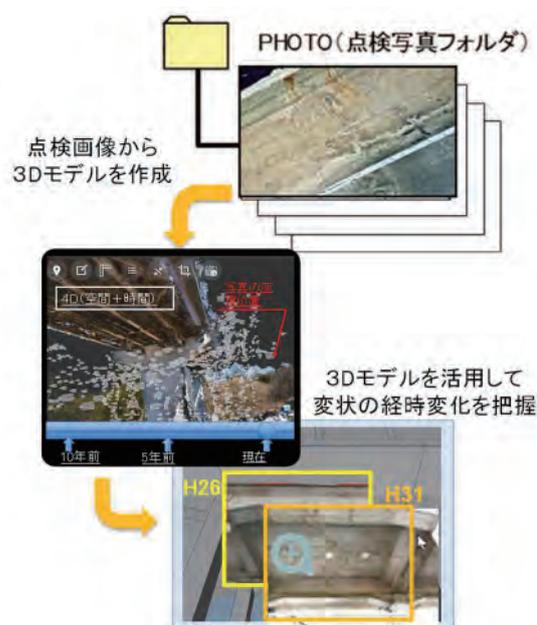
図-2 3次元成果物を用いた調査整理のイメージ
