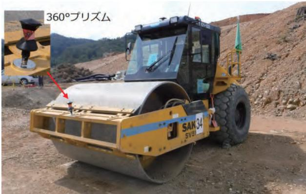
図-2 実験に使用した振動ローラ
