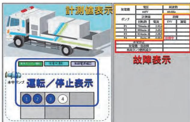
図-2 車両稼働監視画面（一部）
