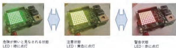
Fig. 1 転倒警告システムの稼働イメージ
