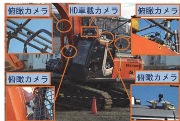
写真-5 カメラ設置状況（俯瞰映像）
