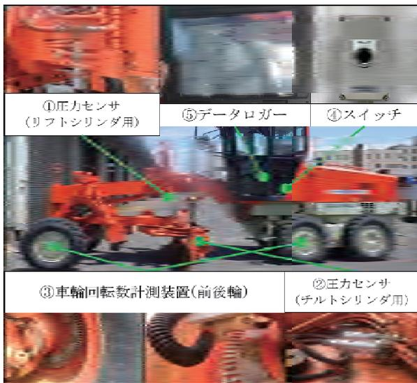
写真-2 センサ、装置取り付け状況
