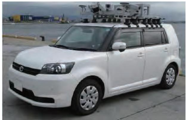
写真-11 MMS搭載車両
