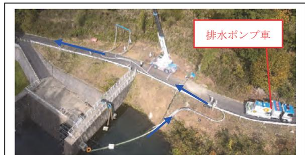
図-9 「災害対策用排水ポンプ車」と「ハイブリッド・S」の組み合わせによる実験状況
