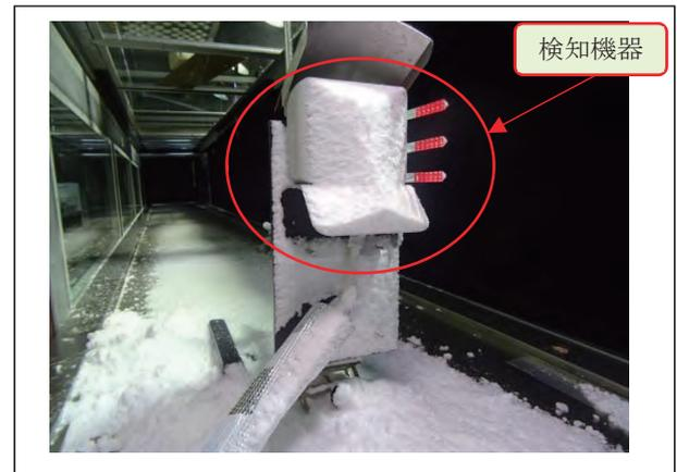
写真2 風洞実験(マイクロ波方式の検知機)
