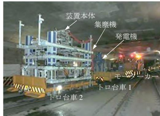
写真-5 研掃装置の車両編成 (地下鉄)
