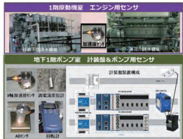
図-8 モニタリングシステムセンサ
