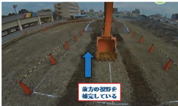
写真-12 俯瞰映像システム（合成映像用前方カメラ）
