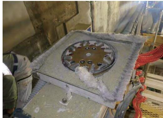
写真-11 粉塵飛散防止枠（ブラシ型）損傷状況
