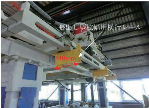
写真-13 張出し型拡幅用横行レール
