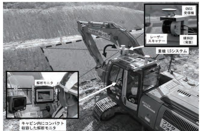
図-1 重機 LS の計測状況とシステム構成
