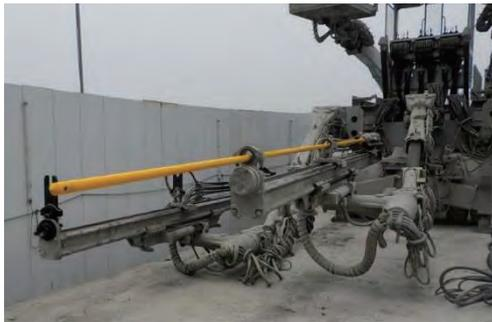
写真—2 モルタル注入装置全景
