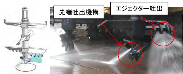
図 2 先端吐出機構とエジェクター吐出
