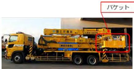
写真-1 橋梁点検車 (型式BT400)
