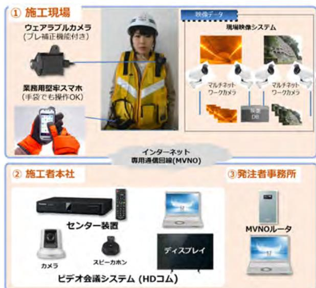
図-2 遠隔臨場システム構成
