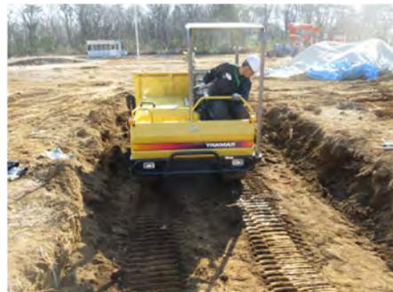
図-3 実験状況(車両沈下量測定)
