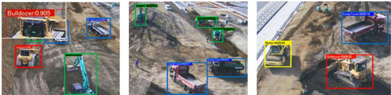
図-6 建機検出 AI での検出結果
