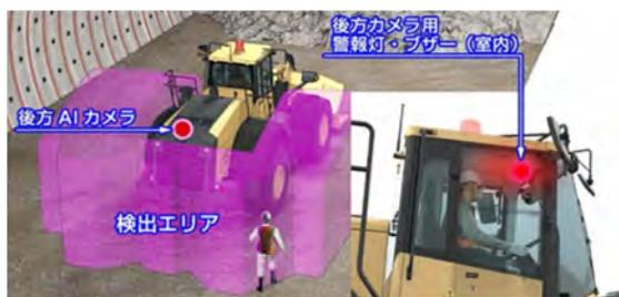
図-4 AI 搭載カメラシステム
