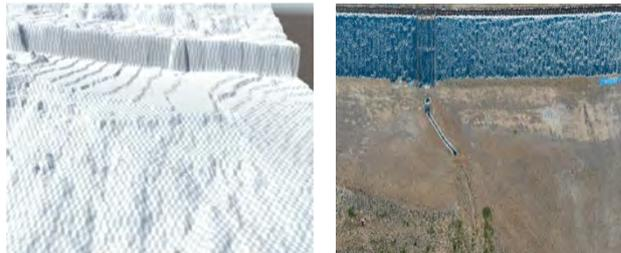
図-9 「Unity」上で標高データより作成した施工現場の地形再現の結果と点群データとの比較(斜面部分)
