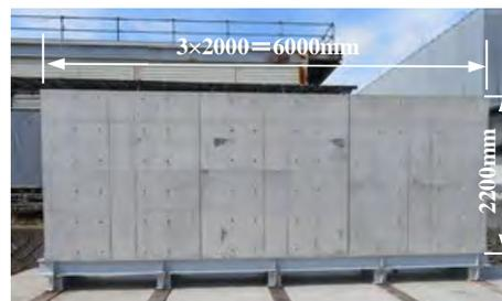
写真-7 RC 壁試験体設置状況
