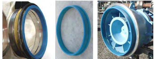
写真-2 排水ホース接続用補助材外観・取付状況
