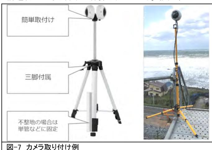
図-7 カメラ取り付け例
