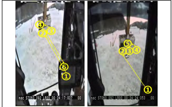
図-5 未熟オペレータの作業確認点
