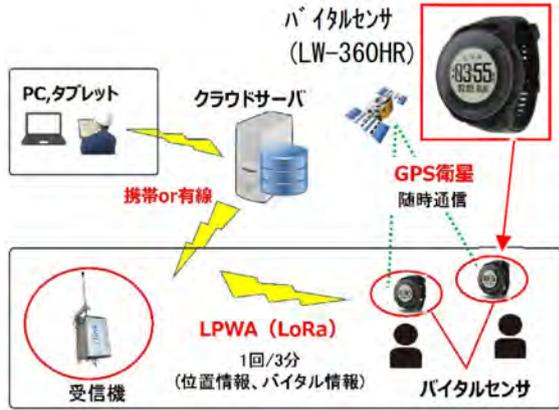
図-4 バイタルセンサシステム概要図
