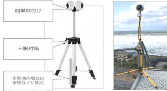
図-8 360° カメラ取り付け事例
