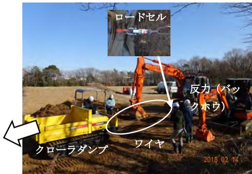
図-1 実験状況(牽引力測定)
