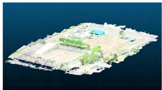
図-10 表面再構成法による施工現場の地形再現手法で使用する点群データ
