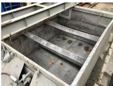
写真-6 使用後のベッセル内部
