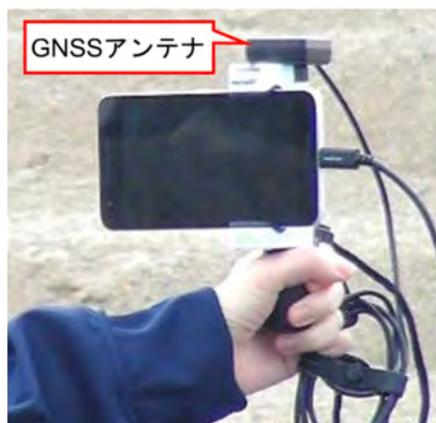
図-2 GNSS アンテナを取り付けた撮影用スマートフォン
