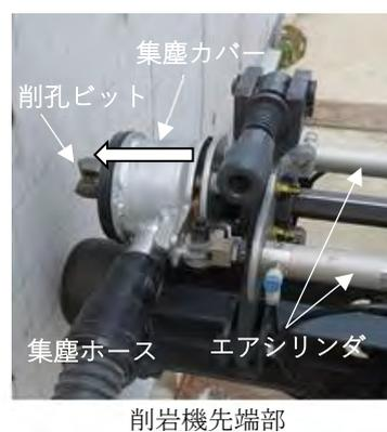
写真-1 自動削孔装置
