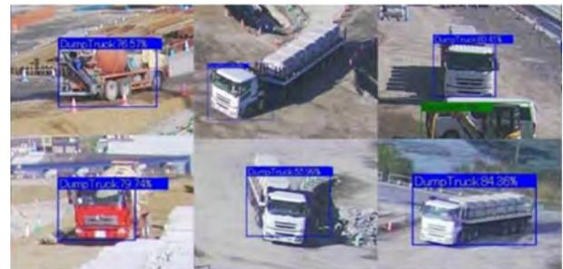
図-7 建機検出 AI がダンプと誤検出した例
