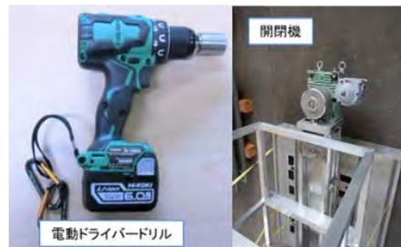
写真-3 電動ドライブドリル、開閉機
