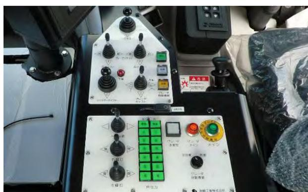
写真-2 除雪トラック作業装置操作レバー
