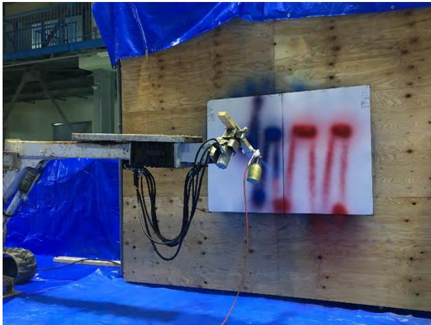
写真-3 塗装吹付による動作比較検証
