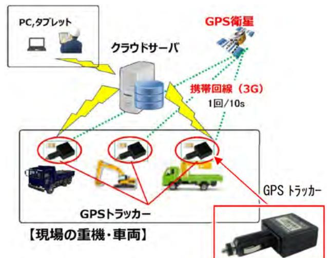
図-3 重機稼働情報システム概要図
