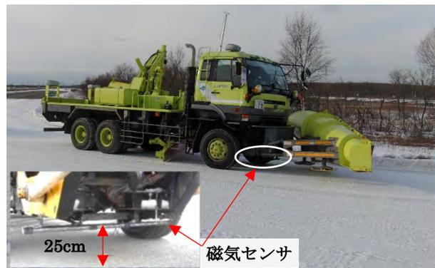
写真-3 磁気センサ設置状況
