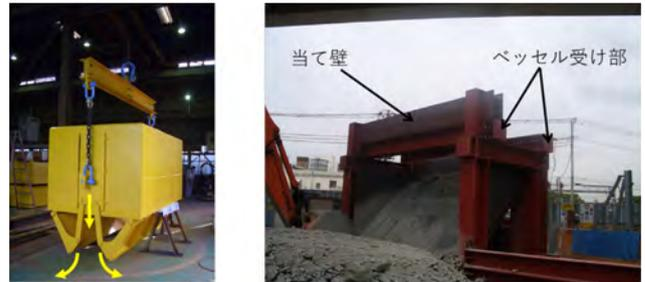
写真-1 従来の底開きベッセルと矩形架台
