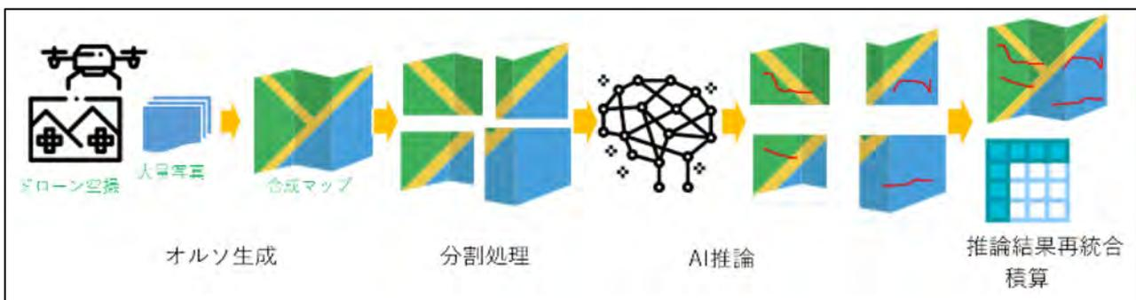
図-5 本測定技術の解析処理フロー
