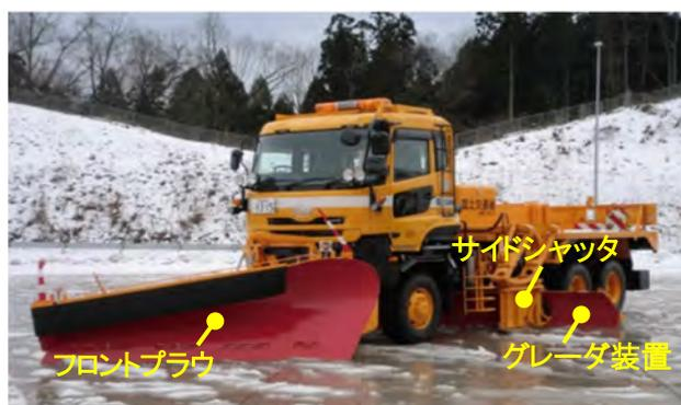
写真-1 除雪トラックの作業装置
