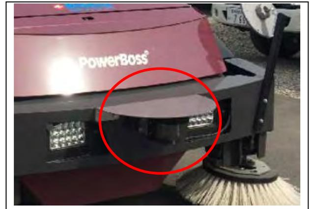
図㉔ レーザーセンサー
