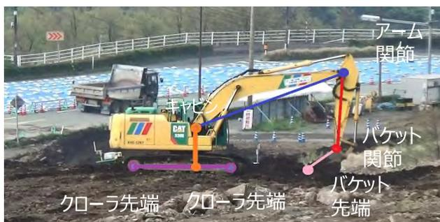
図-3 重機へのOpenPose適用イメージ
