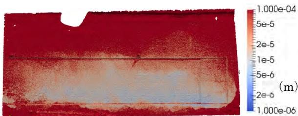
図-5 SfM/MVSによる点間距離
