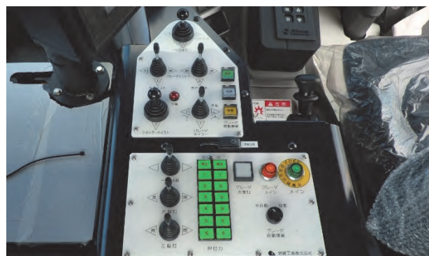
写真-1 作業装置の手動操作パネル
