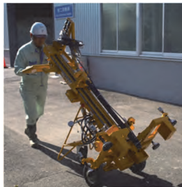
図-2 施工機の人力運搬状況
