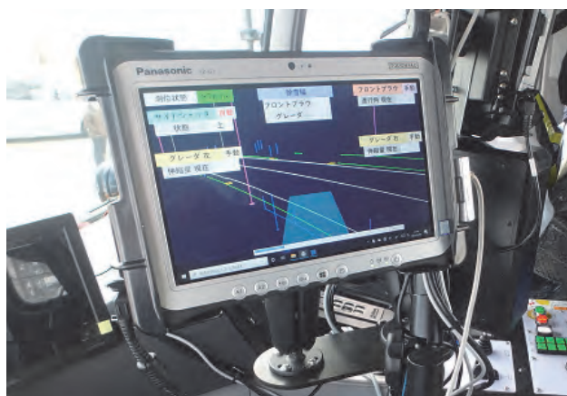
写真-2 自動制御装置
