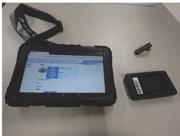
写真-9 遠隔臨場画面(上：工事情報共有システム) と遠隔機器(下：タブレット、ルーター、マイク)
