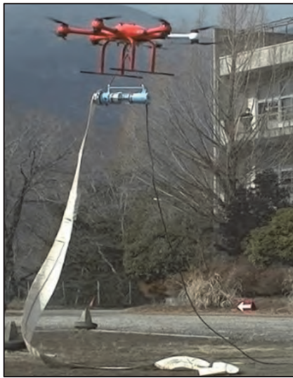
写真—3 ドローンによる運搬
