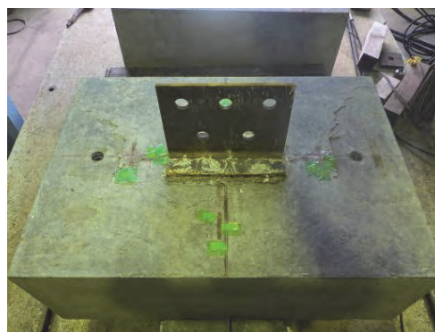
写真-2 引抜試験後の供試体 (BASE01)
