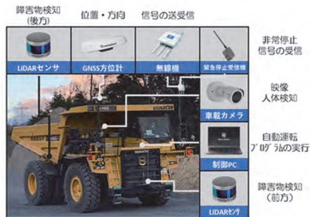
図-2 機器設置状況
