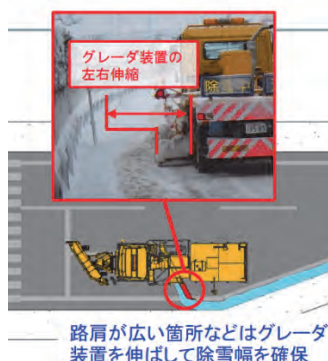
図-6 グレーダ装置の MC 化
