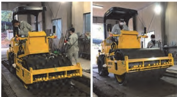
写真-1 締固め試験状況 (左: SVT-5t, 右: SVF-5T)
