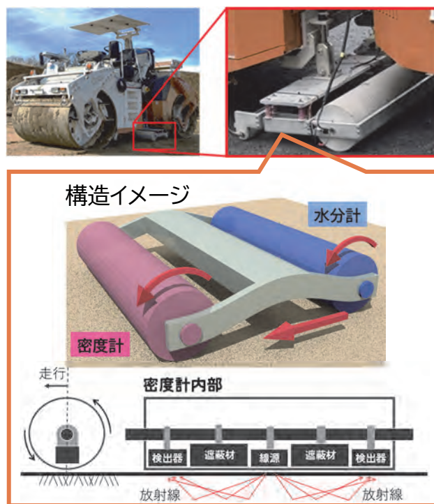
図-6 締固め度自動計測システム
