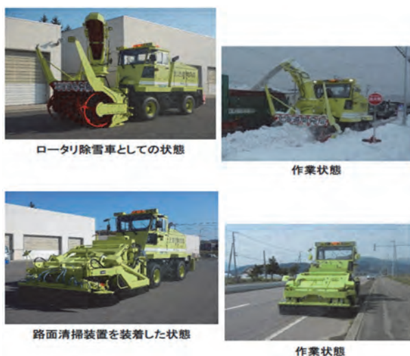
図-2 ロータリ除雪車(路面清掃装置)
