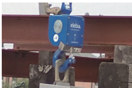
写真-8 自動開閉フック詳細
