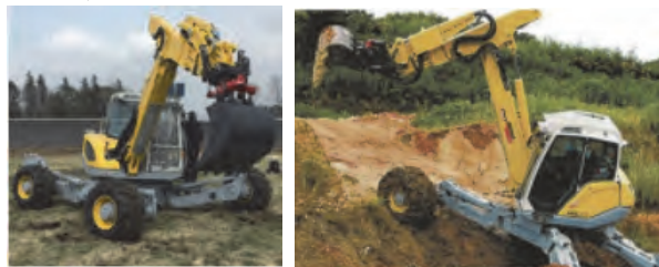
図-7 導入した M545X (左) と国内での施工事例 (右)
