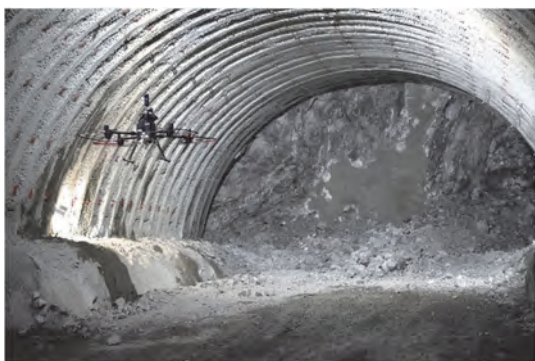
図-6 切羽認識による自律飛行停止
