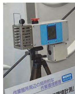
写真-4 ポータブル型作業環境計測
