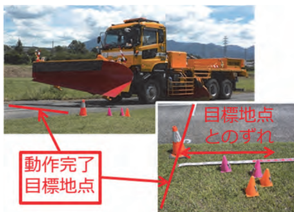
写真-4 自動制御動作精度の確認状況
