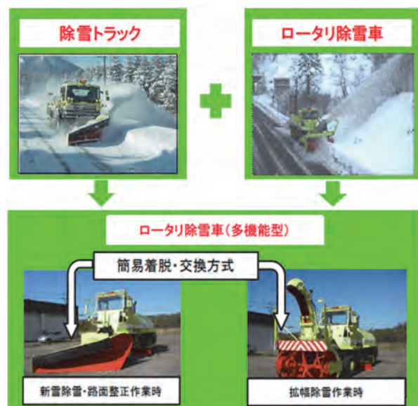
図-1 ロータリ除雪車(多機能型)
