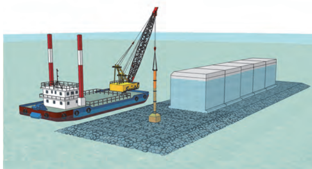
図-2 重錘を用いた基礎マウンド均し
