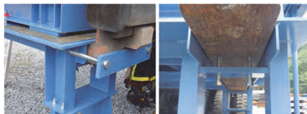
写真-4 心出し装置のフォークへの固定方法
