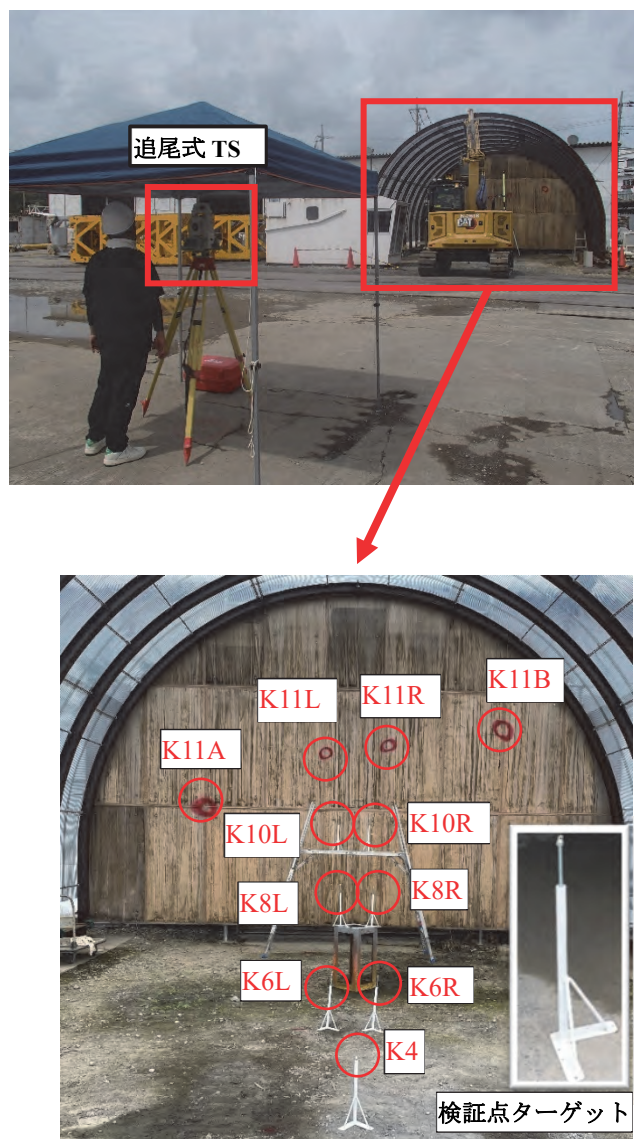
図-3 模擬トンネルにおける精度確認状況
