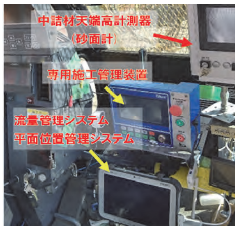
図-3 施工管理計器
