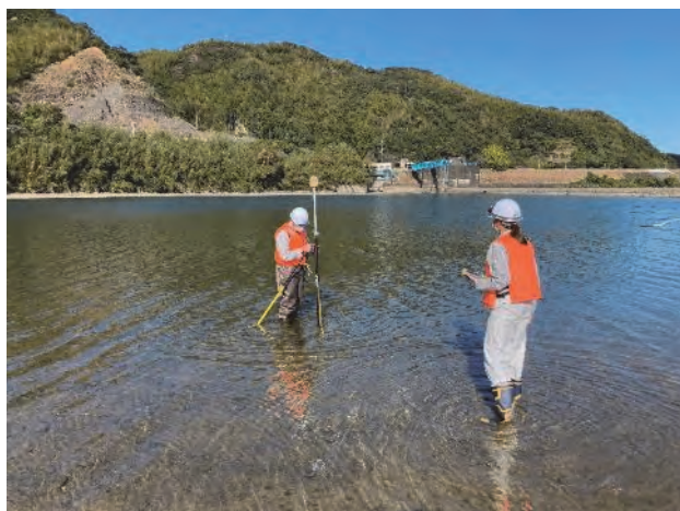
図-9 VRS-GNSS 計測状況
