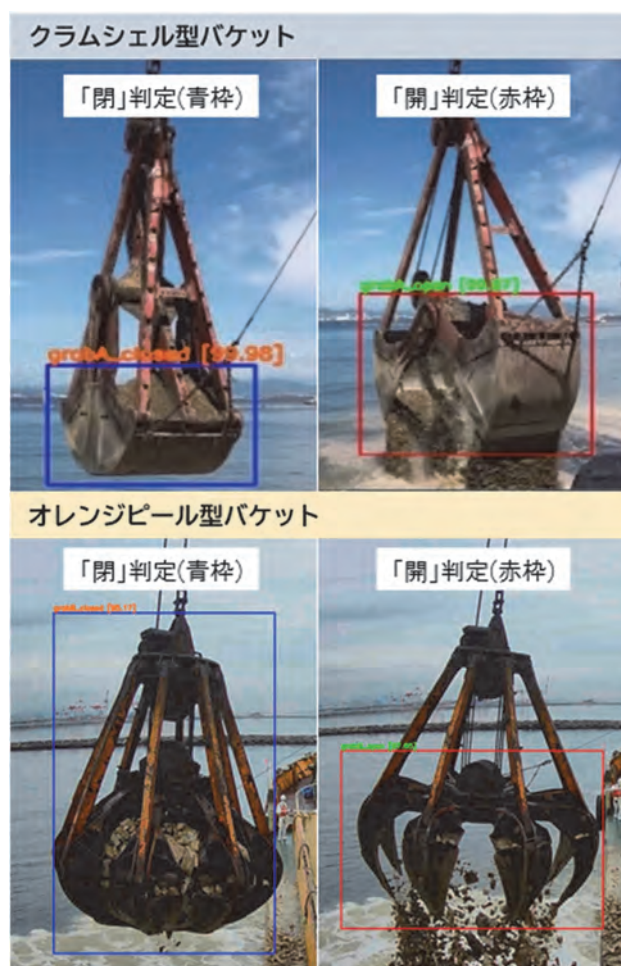
図-12 人工知能 AI による投入(開閉)検知状況
