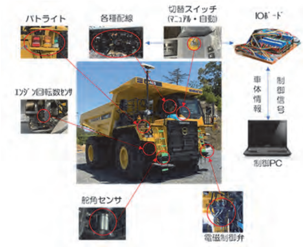
図-1 自動化リジッドダンプ及び改造箇所
