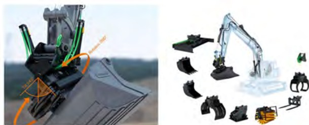
図-1 チルトローテータの機能
