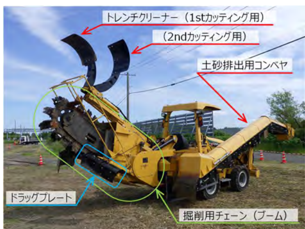
写真-2 機械外観（1200 mm用ブーム装着）
