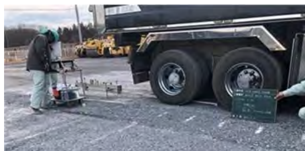
写真-4 ベンケルマンビームたわみ量測定
