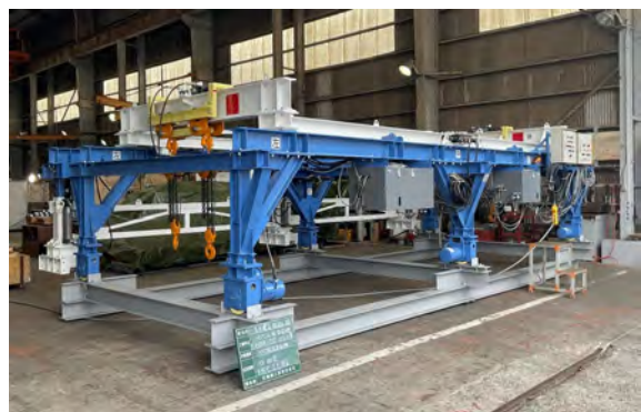
写真-5 本塗装後の床版架設機
