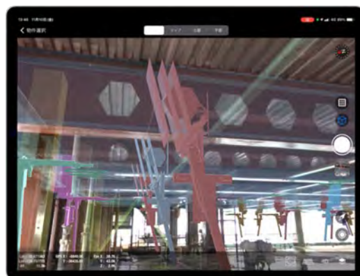
図-13 タブレット端末のARによる鉄骨先行切断位置の可視化
