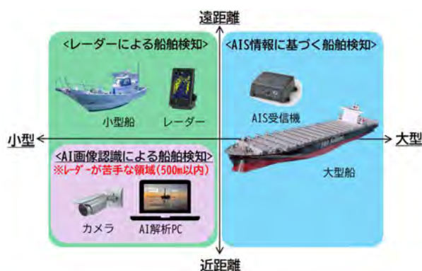
図-1 AI 画像認識技術による船舶検知領域
