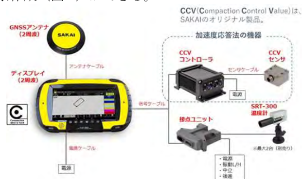
図-1 転圧管理システムの構成
