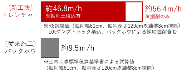
図-3 施工速度（掘削深さ 1200 mm）
