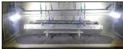
(2) 粘土投入後の堆積状況
