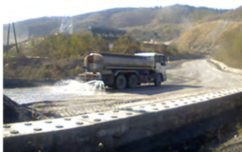
図-1 砕石場での散水による粉じん対策
