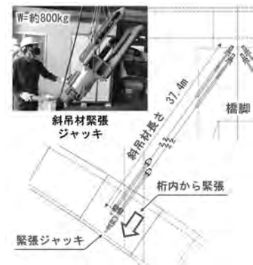
図-3 斜吊材緊張位置
