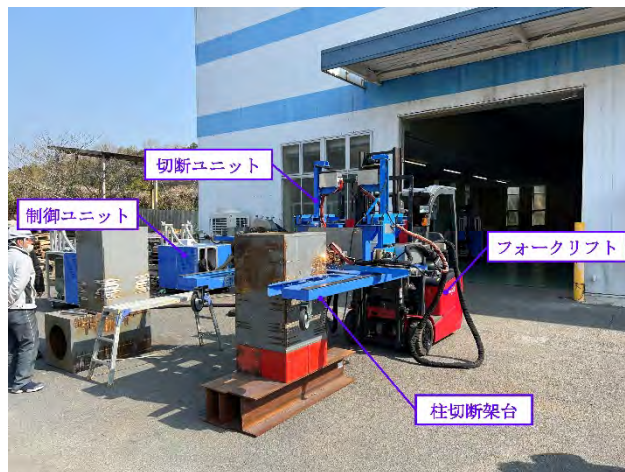
図-9 プラズマ切断装置の切断実験(柱切断)
