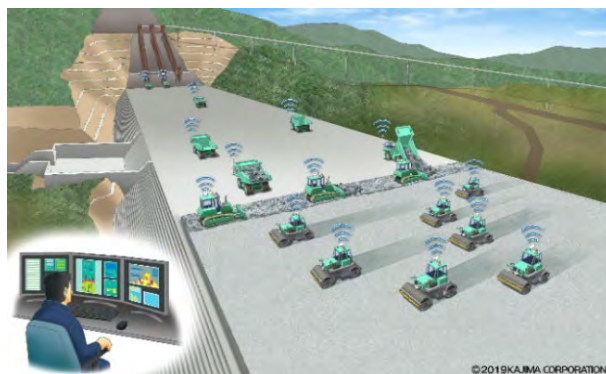
図-1 A 4 CSEL による施工イメージ
