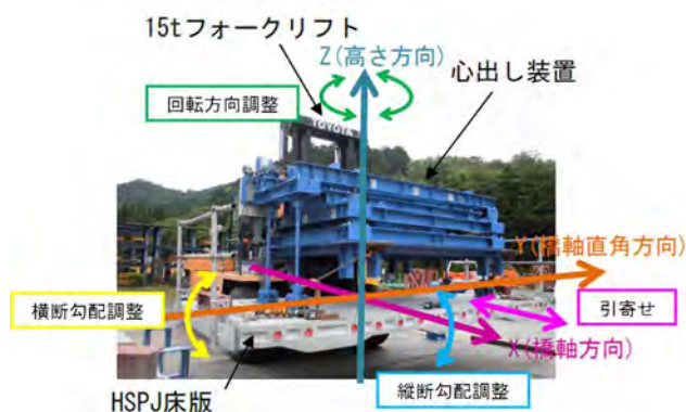
図-4 心出し装置の概要
