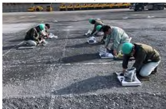
写真-3 砂置換法での密度測定
