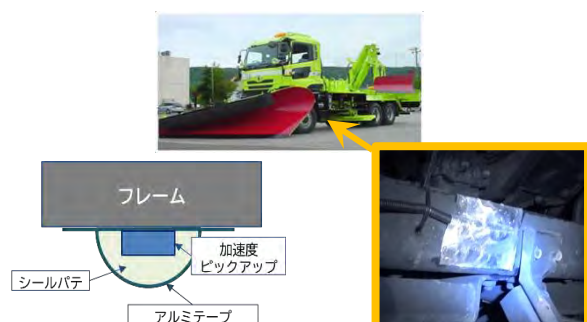
図-2 加速度ピックアップ設置状況
