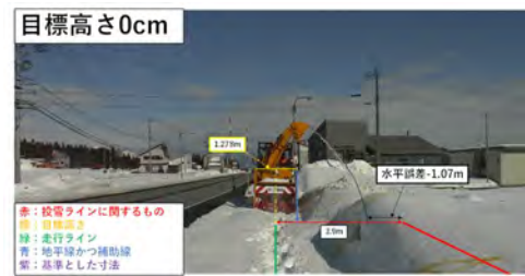
図-4 ライン制御での投雪状況
