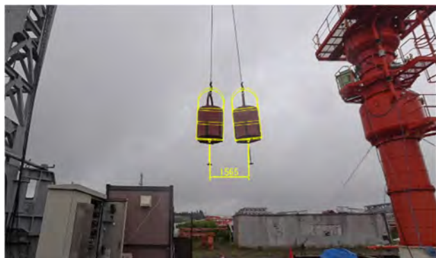
図-12 制振制御 無効時（バケット+錘）
