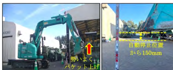
写真-5 検証試験2「バケット上げ検証」
