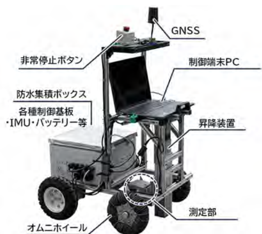
図－3 自動測定ロボットの概要
