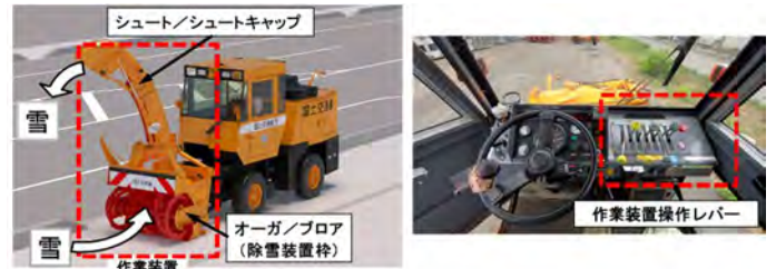
図-1 歩道除雪車の作業装置および操作レバー
