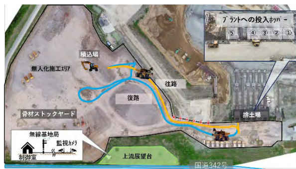
図-6 骨材運搬作業の全体概要
