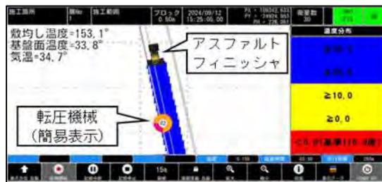
図－6 アスファルトフィニッシャのモニタ画面
