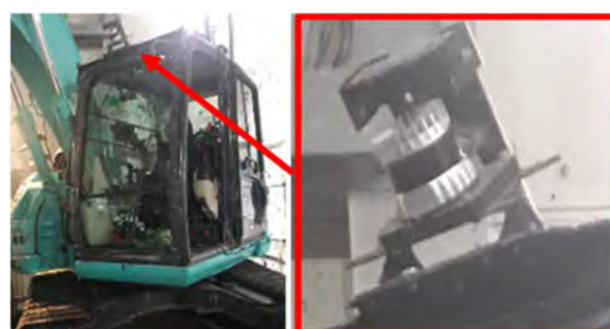
写真-4 搭載した LiDAR
