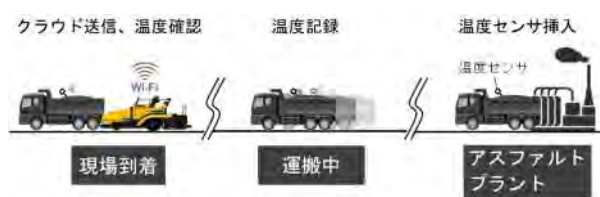
図－1 現場到着温度管理方法の自動化イメージ
