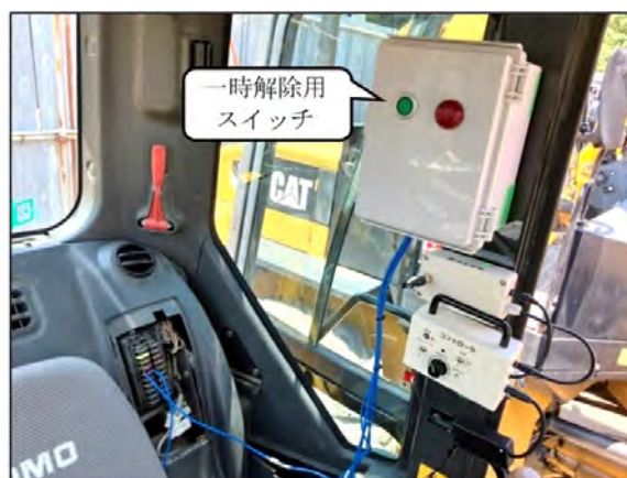
写真-3 自動停止システム取り付け状況
