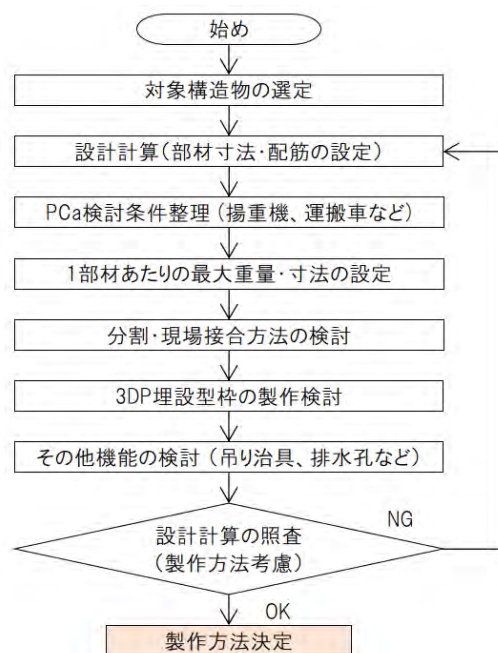
図-2 3DP埋設型枠によるPCa化の検討フロー
