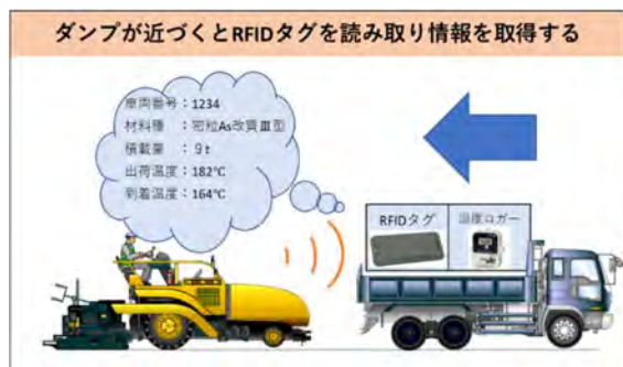
図-4 到着温度の自動取得イメージ
