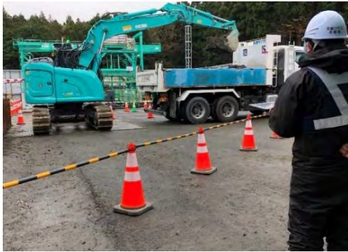
写真-11 タブレットによる自動運転の様子
