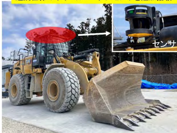
写真-4 レーザースキャナを搭載した遠隔ホイールローダ
