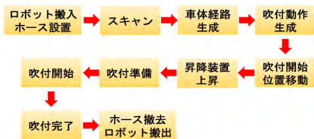
図-10 ロボットによる施工フロー
