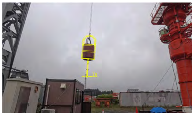
図-13 制振制御 有効時（バケット+錘）
