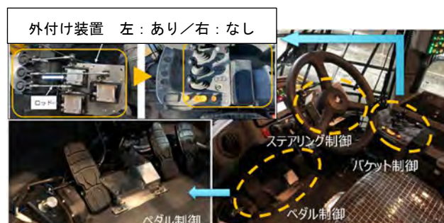
写真-2 遠隔制御装置（運転席内）
