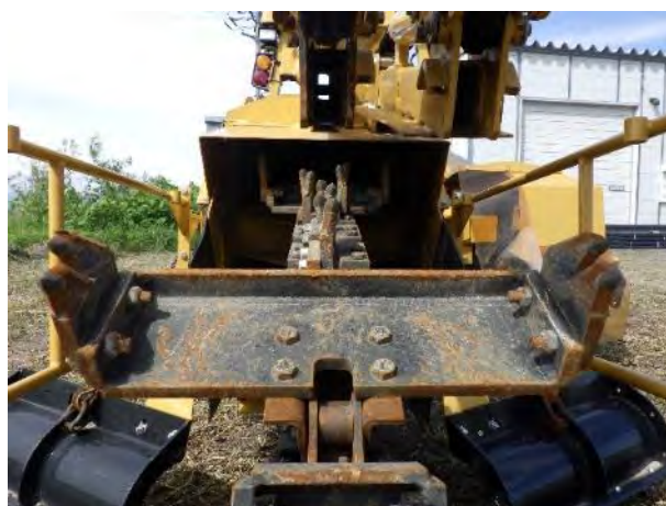
写真-2 掘削刃（幅 610 mm）
