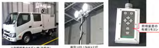
写真-1. 試作機（2灯LED×1.5kW×5.9m）外観
