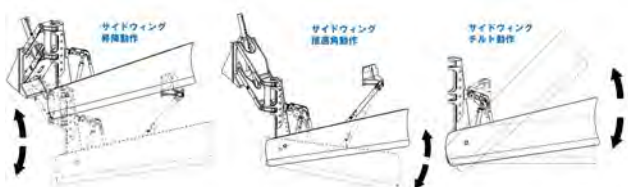
図-6 サイドウィングの自動化
