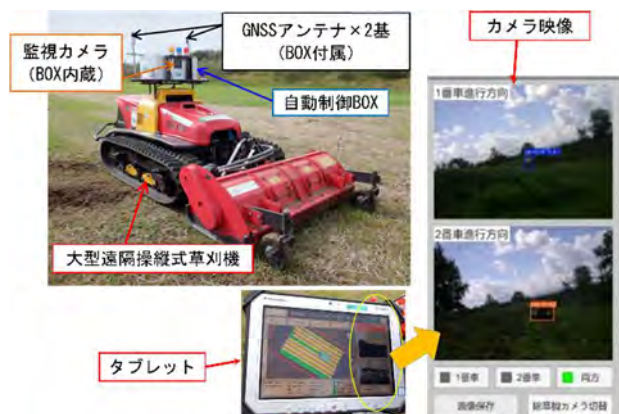
図-5 大型遠隔操縦式草刈機外観・機器構成
