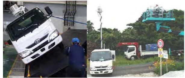
写真-2. 安定傾斜角試験（左）、風圧転倒試験（右）
