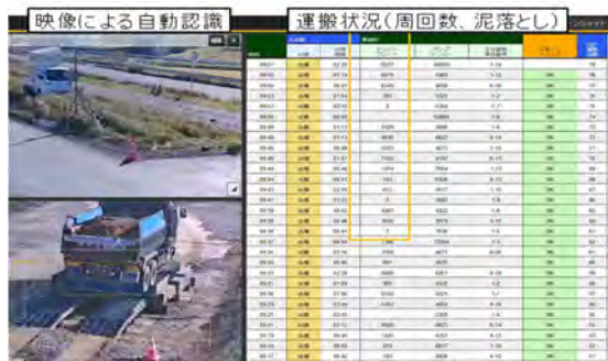
図-10 映像によるダンプトラックの入退場・泥落としの管理
