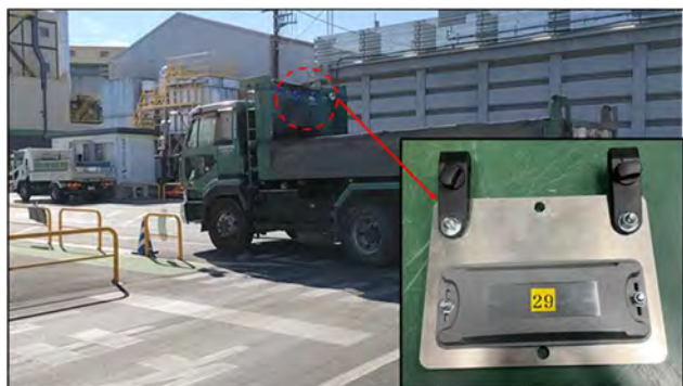
図-2 RFID タグ設置状況
