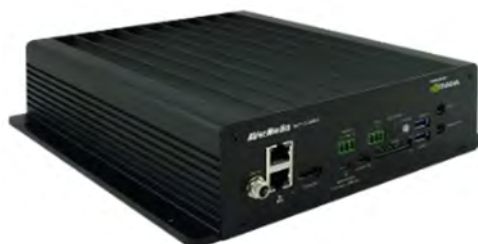
写真-3 周囲認識コントローラ
