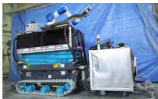
写真-1 耐火被覆吹付ロボット(2020年)
