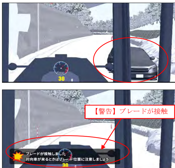
図-5 ヒヤリハット事例（対応車との接触事故回避）
