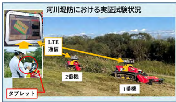
図-10 河川堤防における協調運転実証試験状況
