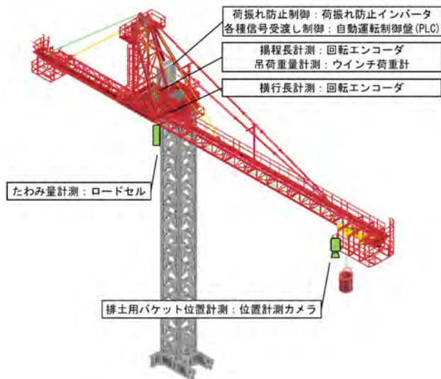
図-4 排土クレーンおよび制御用機器
