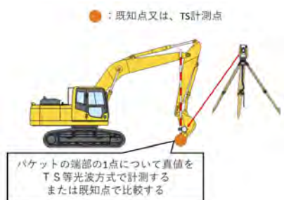
図-9 刃先計測精度の事前確認方法例（上）と日々の精度確認（下）
