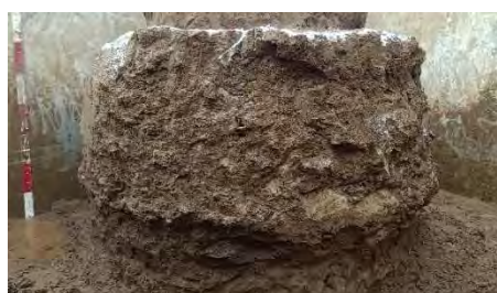
写真-4 掘削した改良体（側面）
