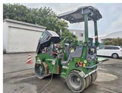
写真－1 舗装用電動ローラ外観
