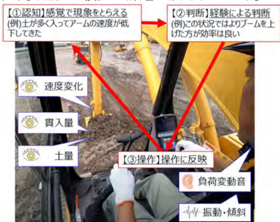
図-1 オペレータの掘削操作
