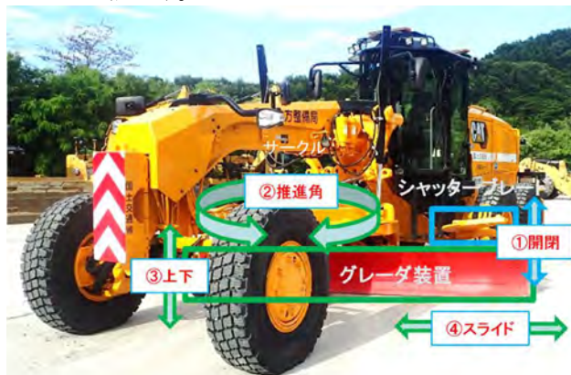
図-7 除雪グレーダの作業装置自動化
