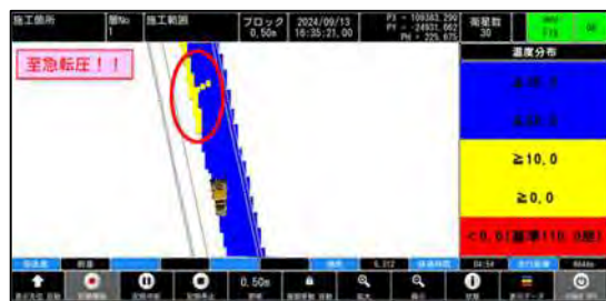
図-10 転圧機械に設置したモニタ上の警告表示
