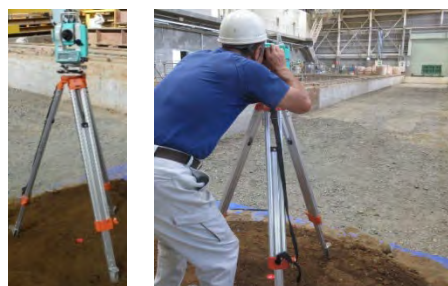
写真-1 従来の TS を用いた観測状況
