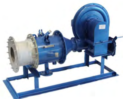
図2-1 水素バーナ（出力500kW）
