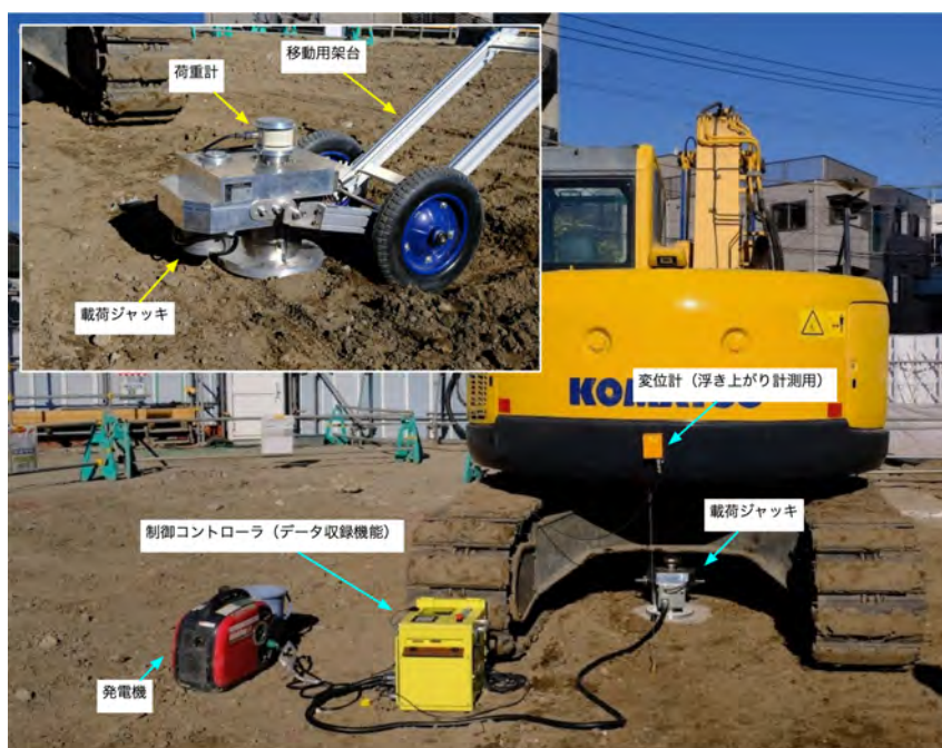
図-1 現場地耐力試験(BCT)の概要
