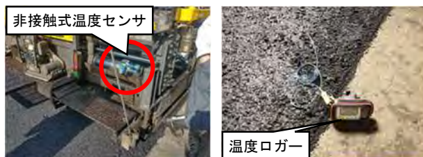
写真－1 敷きならし直後の表面温度と内部温度測定状況
