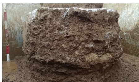
写真-4 掘削した改良体（側面）
