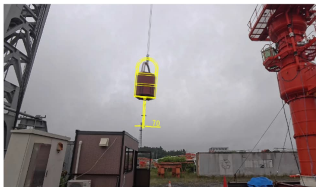
図-13 制振制御 有効時（バケット+錘）
