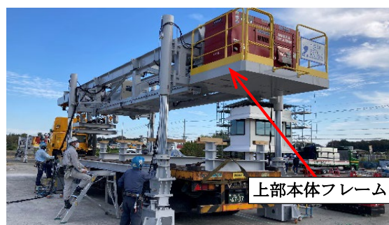
写真-9 上部本体フレーム組立状況
