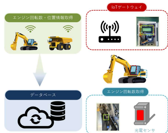
図-1 『N-ECOMS(ネコムズ)』システム構成
