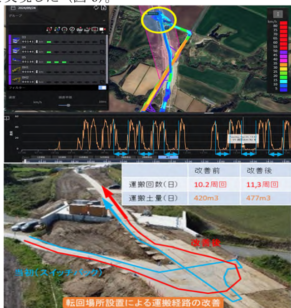
図-5 施工計画シミュレーションによる運搬経路の最適化
