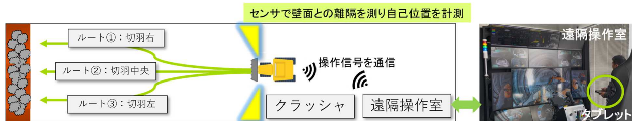
写真-4 レーザースキャナを搭載した遠隔ホイールローダ
