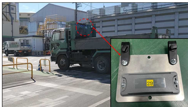
図-2 RFID タグ設置状況
