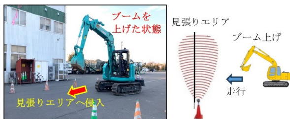
写真-4 検証試験1「見張りエリア侵入検証」
