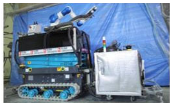
写真-1 耐火被覆吹付ロボット(2020年)
