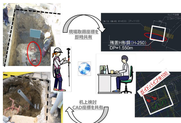
図-7 埋設管試掘後の測位結果共有例
