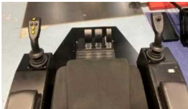
ジョイスティックレバー操作方式
