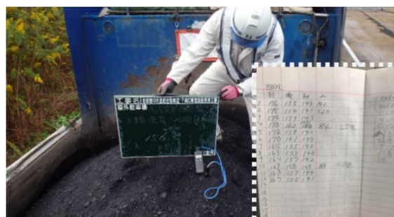
図-9 従来の到着温度計測状況
