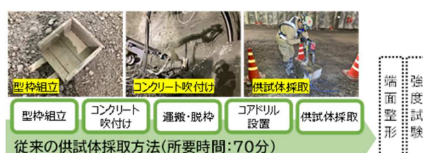
図-1 従来の供試体採取手順
