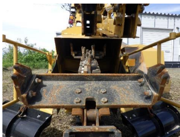
写真-2 掘削刃（幅 610 mm）
