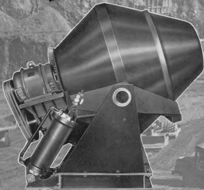
↑ 新王子式 56切 1.55 m 3 傾斜型コンクリートミキサ (5t, 20HP) 製作：昭和33年5月
