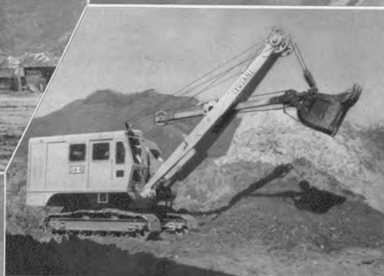
油谷式 24-BⅢ 0.6m 3 ディーゼル ショベル 製作：昭和34年3月
