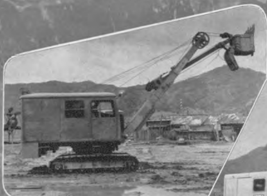
油谷式 24-A 0.5m 3 ディーゼルショベル 製作：昭和25年3月
