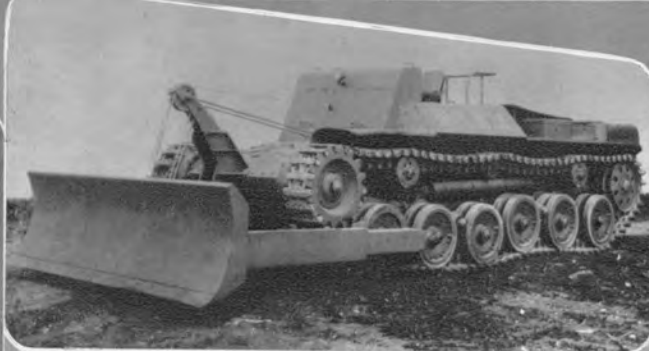
↑ 三菱 中戦車改造排土車 製作開始：昭和20年12月
