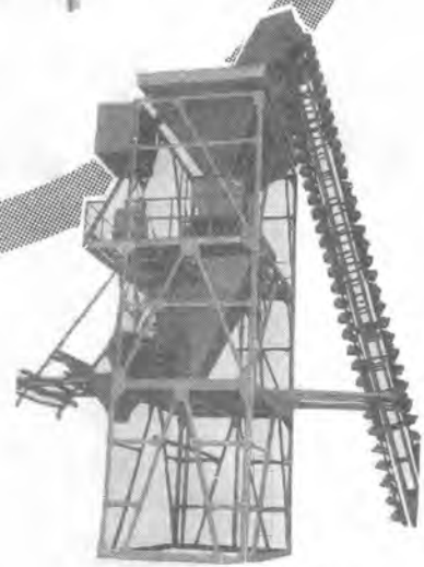
バッチャープラント
