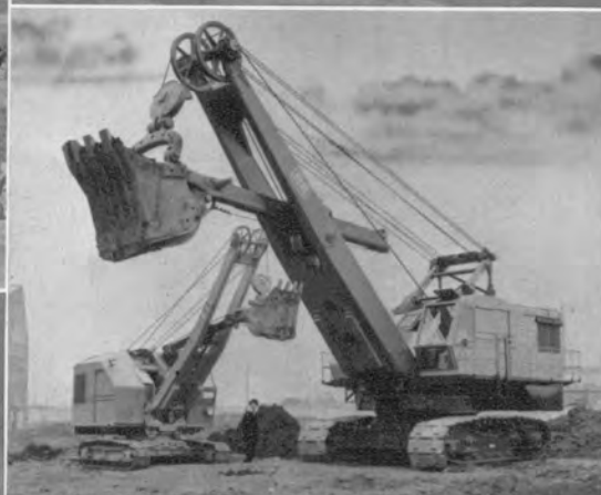
日立 U23型(2.3m 3 ) および U03型(0.3m 3 ) パワーショベル 製作：U03 昭和30年4月 U23 昭和33年3月
