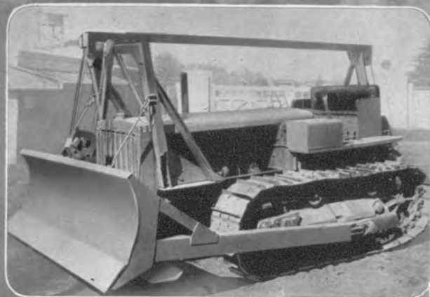
↑ 小倉製鋼 KTA-70型ブルドーザ(13t) 製作：第1号機 昭和22年10月
