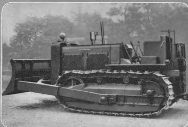
↑ 三菱 BBⅡ型アングルドーザ(9t) 製作開始：昭和24年1月
