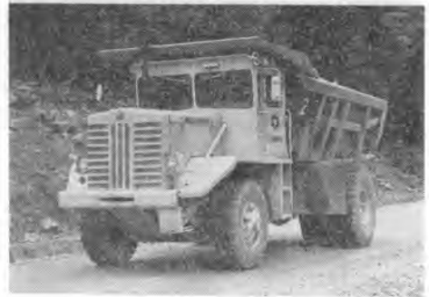
写真-3 大町ルートにおけるパイホーラダンプトラック
