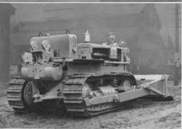
↑ 小松 D120-5型アングルドーザ(トルコン付) 183PS/1,250rpm 23,700kg 製作：昭和31年
