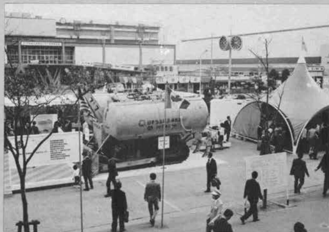
60m水中ブルドーザ(JH 360形)▶ 作業水深：5～60m 走行駆動：電動油圧式
