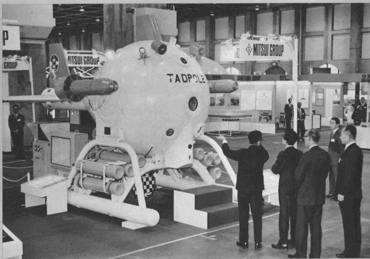
▲ダイビングチャンパー 寸 法：5.3×3.5×3.5m 乗 員：2名 作業時間：4時間
