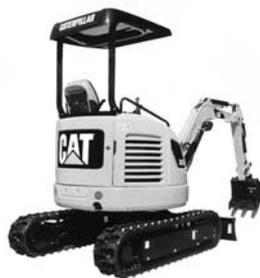
写真一 新キャタピラー三菱「REGA」CAT302C CR ミニショベル (後方超小旋回形)
