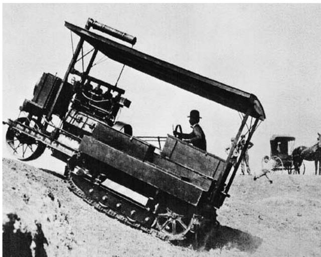
写真一 ホルト社製装軌式トラクタ
