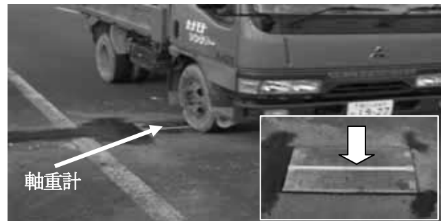
写真三 車両通過状況とセンサ設置状況
