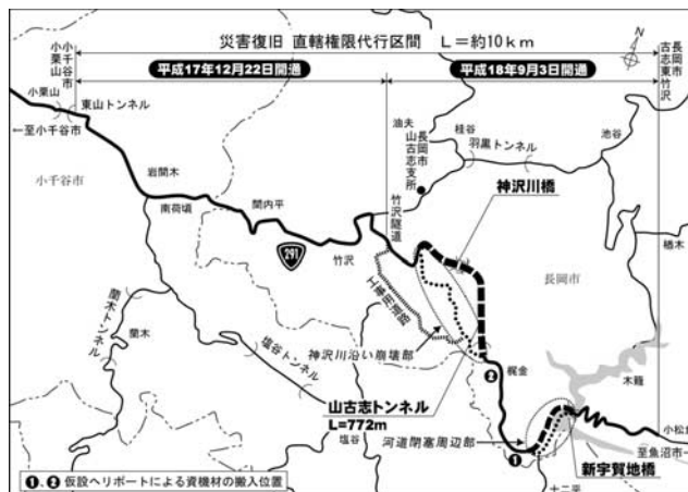
図一 一般国道 291 号直轄権限代行災害復旧区間
