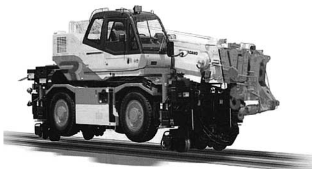
写真一 2 タダノ GR-180N ラフテレーンクレーン (軌陸仕様車)
