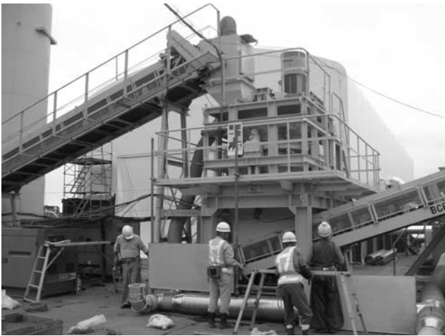
写真一 回転式破砕混合装置概観
