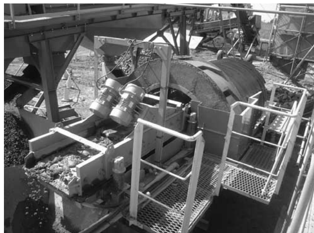
写真-2 重力沈降分離式土砂脱水篩機
