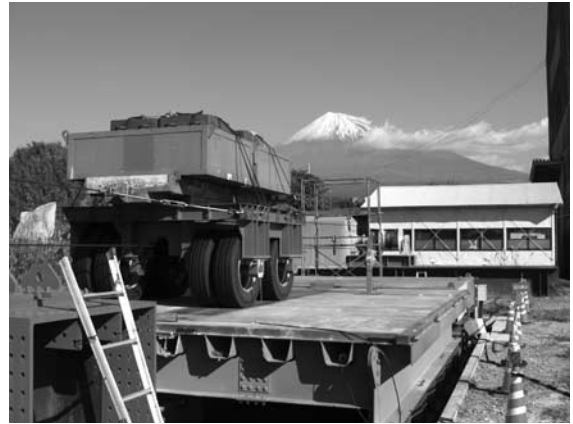
写真—3 移動載荷疲労試験 (国土交通省より受託)
