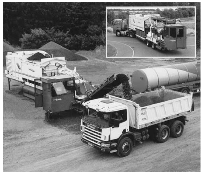
写真—4 WIRTGEN 社製フォームドアスファルトプラント（タイプ KMA200）
