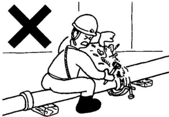
コンクリート輸送管内残圧除去
