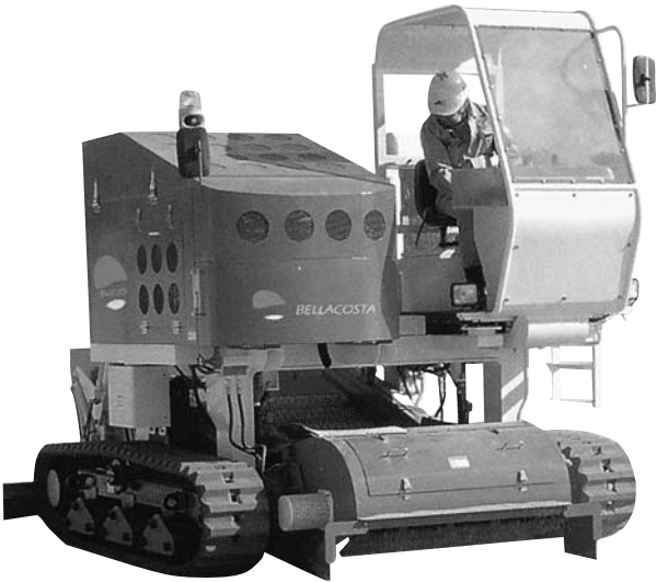
写真－5 新キャタピラー三菱 BELLACOSTA 自走式ビーチクリーナ
