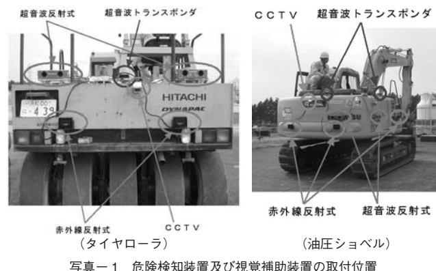
写真-1 危険検知装置及び視覚補助装置の取付位置
