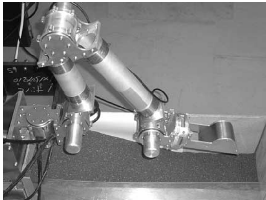
図—7 知能化パワーショベル模型による掘削実験
