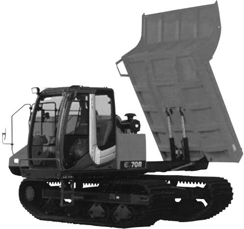
写真ー5 日立建機 EG70R-3 不整地運搬車 (全旋回式)
