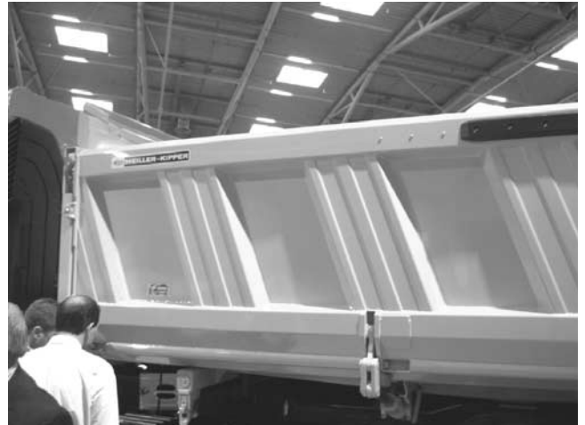
写真— 25 一般的な斜めスチフナのボデー
