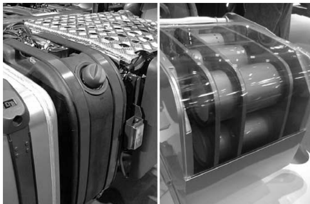
写真—22 AdBlueのタンクとSCRカットモデル
