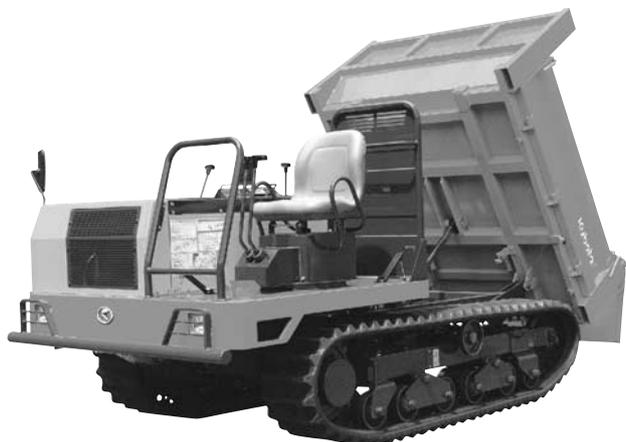
写真一六 クボタ「ZEPH」RG-30C-2 不整地運搬車
