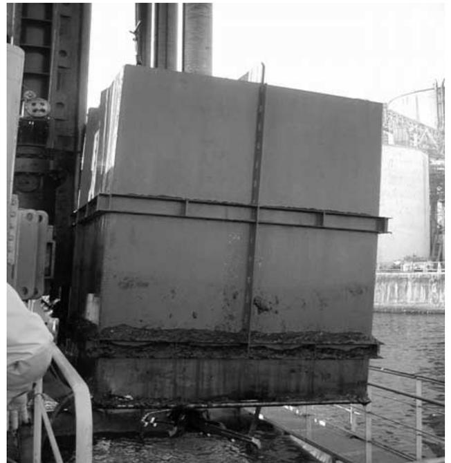
写真-2 鋼製攪拌翼カバー
