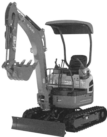
写真一三ー一 クボタ「ZEPH」U-15-3S（後方超小旋回形）ミニショベル
