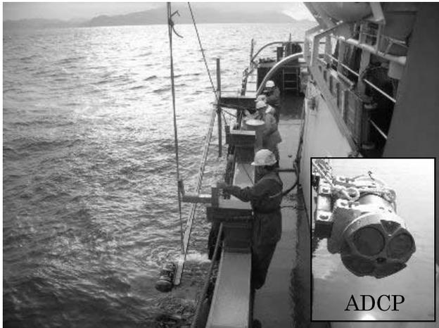
写真一 流向流速計測状況
