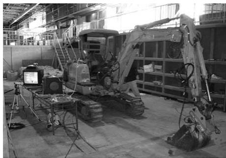
写真—2 陸上実験機 (0.09 m³ 級バックホウ)
