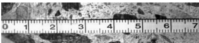
写真—3 孔内にスケールを貼付したスキャニング画像
