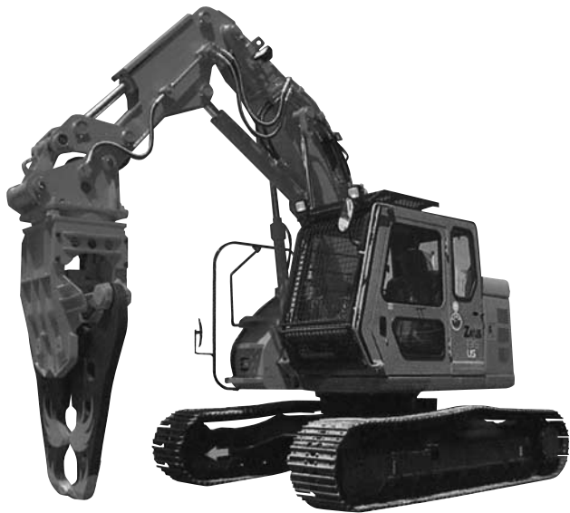
写真一 2 日立建機 ZX135USK 油圧ショベル（後方超小旋回形・解体仕様）
