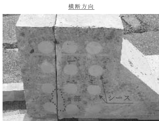
写真—3 注入材の充填状況 (a部が注入箇所) (無収縮セメントスラリータイプ、真空注入)
