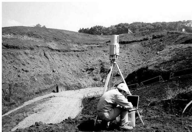
写真—2 3次元レーザースキャナーでの計測状況
