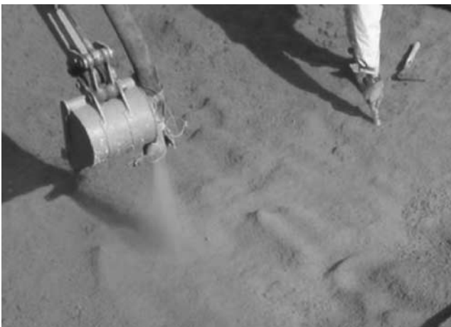
写真—6 土壌硬度測定状況
