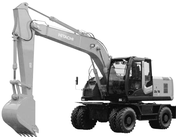
写真—3 日立建機 ZX170W-3 油圧ショベル（ホイール式）
