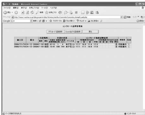
図—5 Web 画面（コンクリート強度試験）
