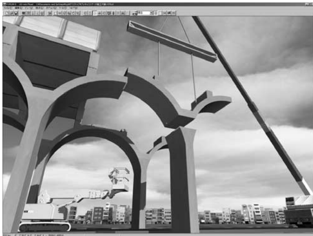
図—9 半割りアーチ梁の架設
