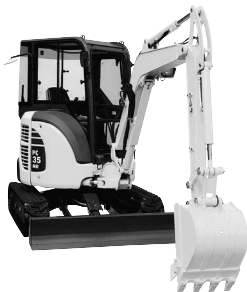
写真1-2-2 コマツ「GALEO」PC35MR-3 ミニショベル（後方超小旋回形）
