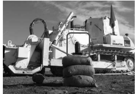
写真—14 対人地雷を用いた耐爆テスト
