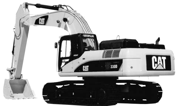
写真—1 新キャタピラー三菱「REGA」CAT 330D 油圧ショベル
