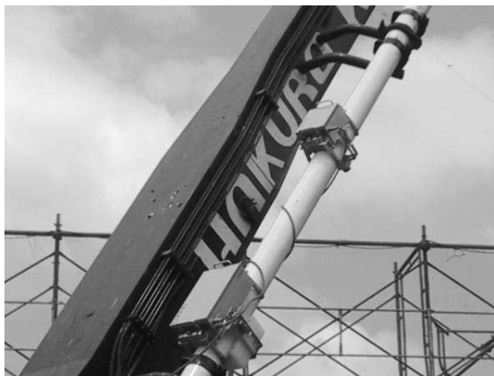
写真—1 コンクリートポンプ車の圧送配管への機器設置状況とデータ処理部
