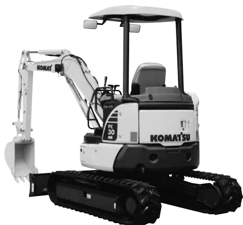
写真1-2-1 コマツ「GALEO」PC30MR-3 ミニショベル（後方超小旋回形）
