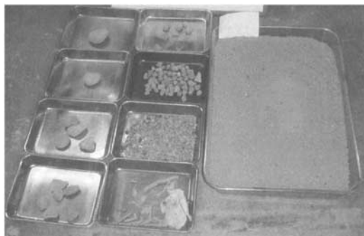
写真-4 ふるい分けした汚泥（乾燥状態）
