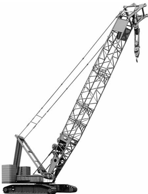
写真一 5 コベルコクレーン SL6000J-500 クローラークレーン
