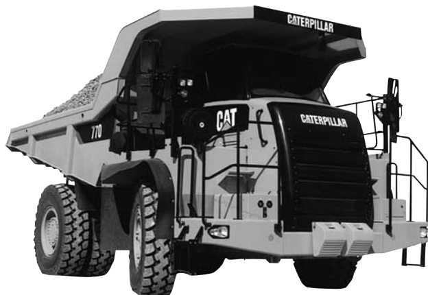
写真一 4 新キャタピラー三菱 CAT770 重ダンプトラック
