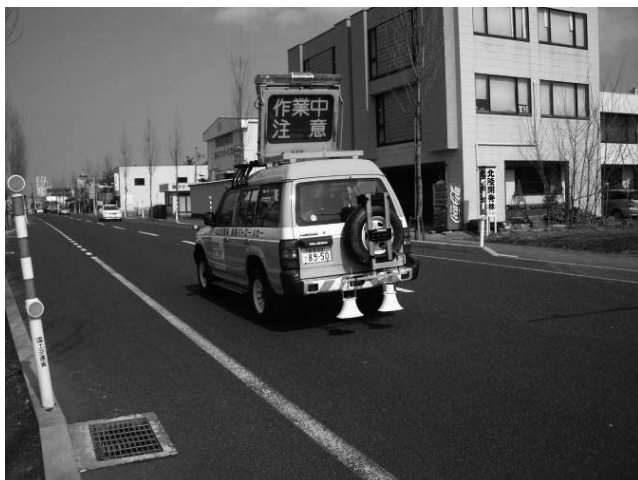
写真—1 路面反射音計測・評価システムの計測状況
