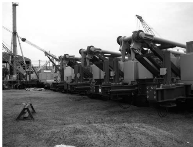
写真—6 大型杭打機 (DH658)
