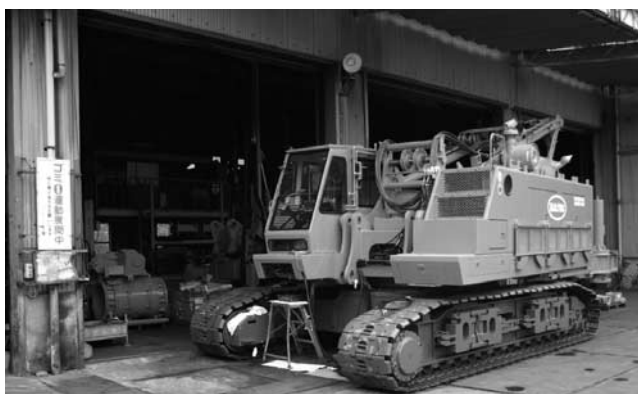
写真—8 特殊改造組立中の杭打機
