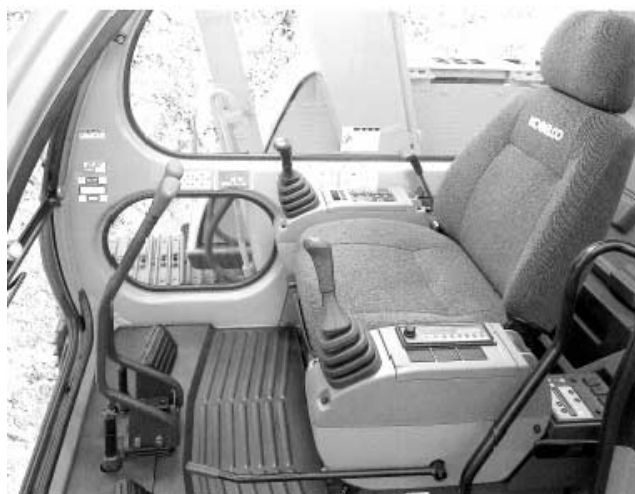
写真—3 旧型機の丸型キャブ室内
