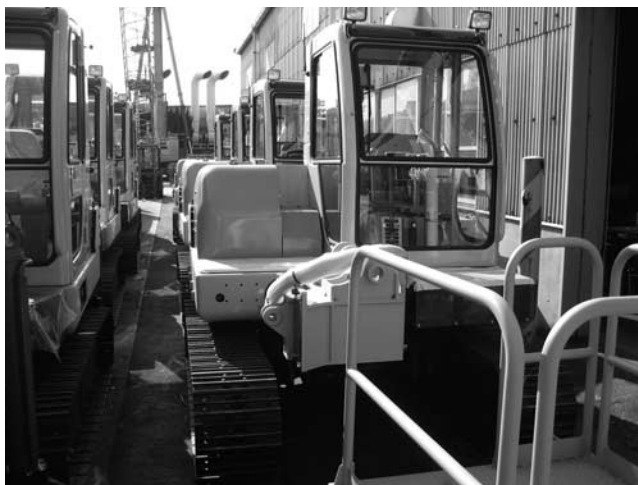
写真—7 小型杭打機
