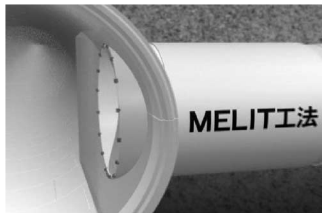
図—1 MELIT 掘進機接合状況
