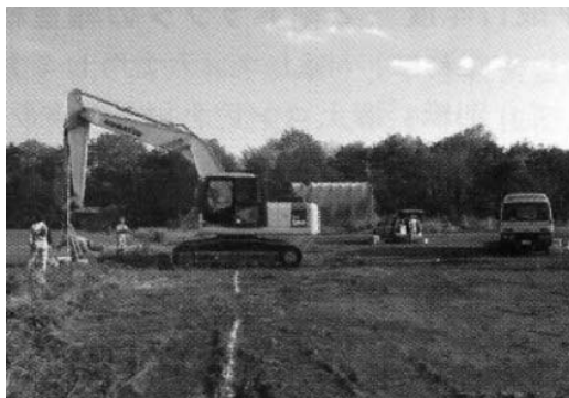
図—2 低振動型建設機械の振動証明試験
