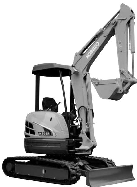
写真—3 コベルコ建機「Beetle」SK30SR-5 ミニショベル（後方超小旋回形）
