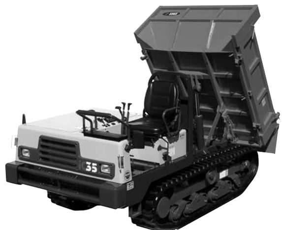
写真一6 石川島建機 IC35 不整地運搬車
