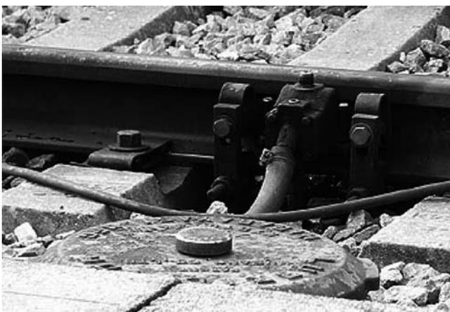
写真—3 レール塗油器(手前の蓋は油タンク)
