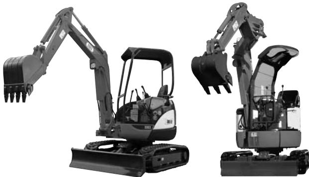
写真一5 石川島建機 30VX ミニショベル（後方超小旋回形）（左）と 20VZ（超小旋回形）（右）
