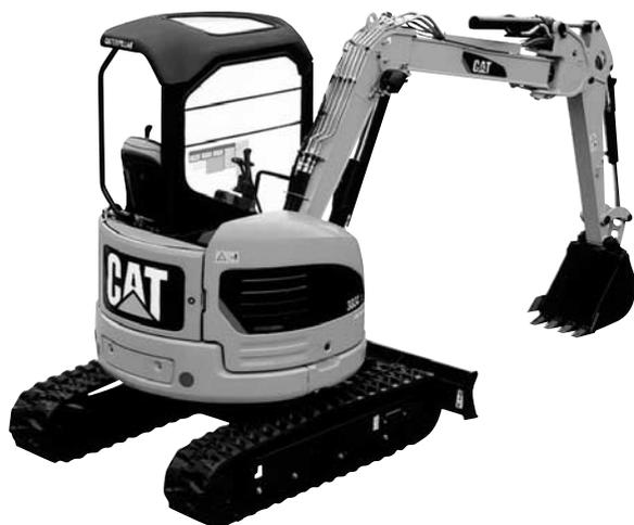
写真-4 新キャタピラ-三菱「REGA」CAT303C SR ミニショベル (超小旋回形)
