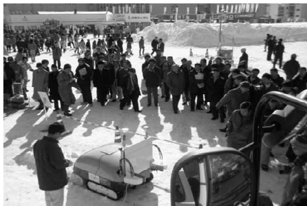
写真—10 自立運行型除雪ロボット「ゆき太郎」
