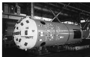
写真—2 パイロット TBM
