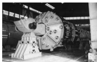
写真—3 リーミング TBM
