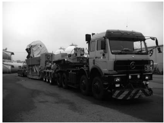
写真—3 発電機輸送状況
