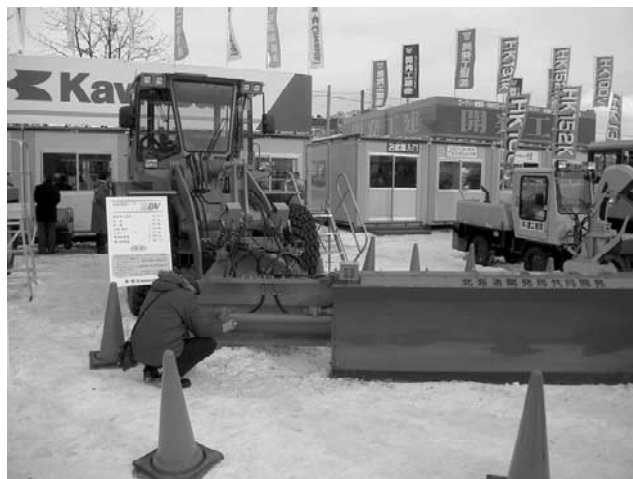
写真—9 除雪ドーザ（サイドスライドブレード）
