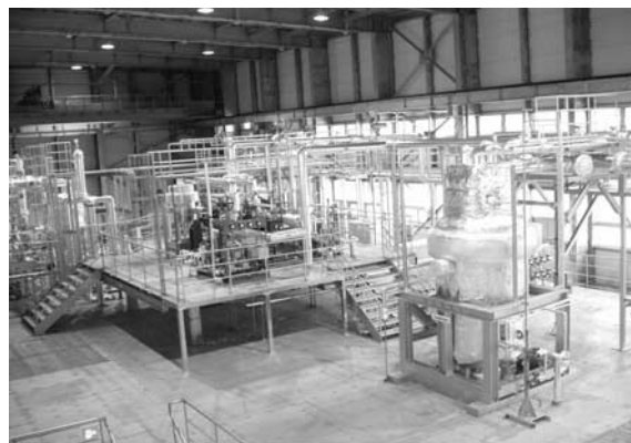
図—2 30 kW 海洋温度差発電システム（佐賀大学）
