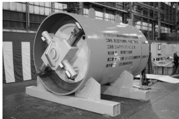
写真-1 φ1600 mm DAPPI 掘進機
