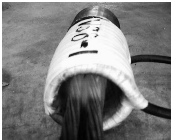
写真—1 PC 鋼線加熱状況
