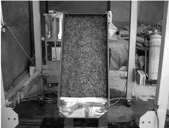
写真一10 人工降雨装置による耐侵食性確認状況
