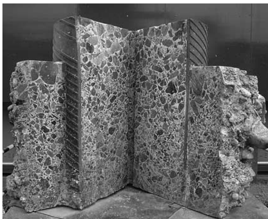
写真一 杭先端部の造成状況（砂礫地盤） （現場造成杭を掘り起こし後に切断し断面を撮影）
