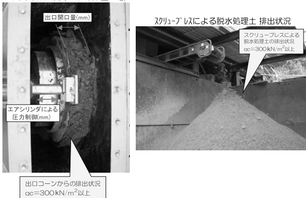
写真-8 脱水処理土の状況（クーン指数：300 kN/m² 以上）
