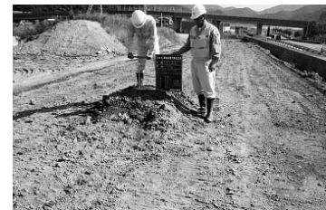
写真一十四 現場 3 日強度 コーン指数確認状況
