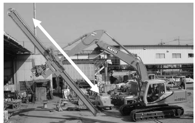
写真一15 バックホウ取付 縦・横スライド吹付ノズルアタッチメント（汎用機取付対応）
