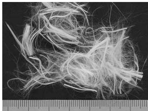
写真—9 湿式不織布用ポリエステル短繊維 (カット長 15 mm, 織度 1.7 dtex)
