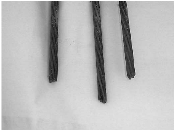
写真一6 PC鋼線切断状況
