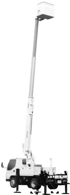
写真ー４ アイチコーポレーション「スカイマスター」SH12A 高所作業車
