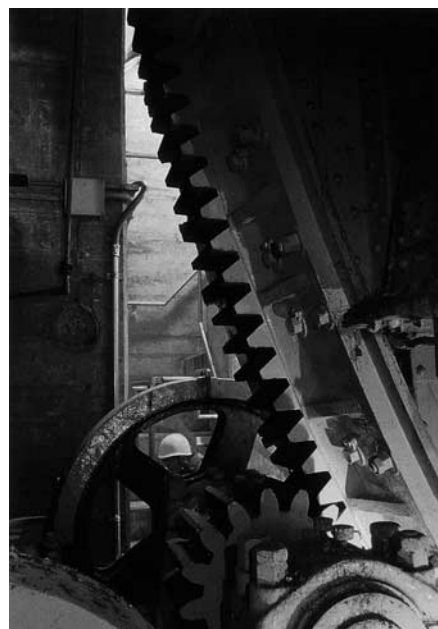
写真—2 橋脚内のギア 小さなギアの回転を巨大なギアへ伝え、橋桁をあげる。
