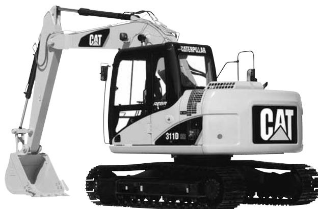
写真—1 新キャタピラー三菱「REGA」CAT311D RR 油圧ショベル
