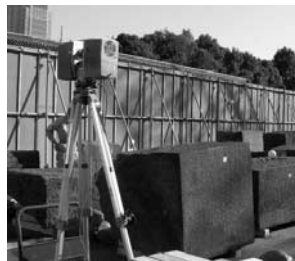
写真—4 石材の計測作業
