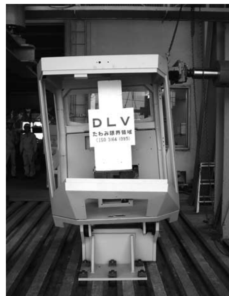
写真—1 SV512-1 側方載荷終了時
