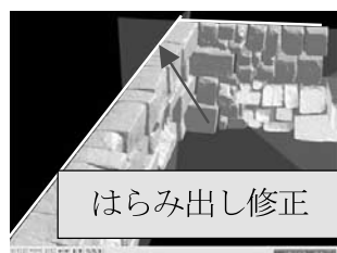
図—10 石垣半自動修復
