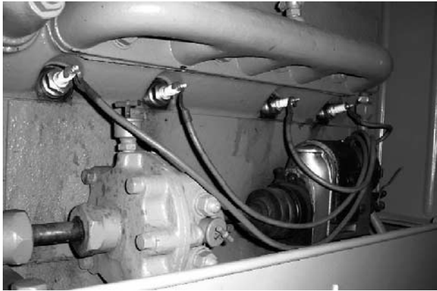
写真-5 エンジン左側の点火系統部品
