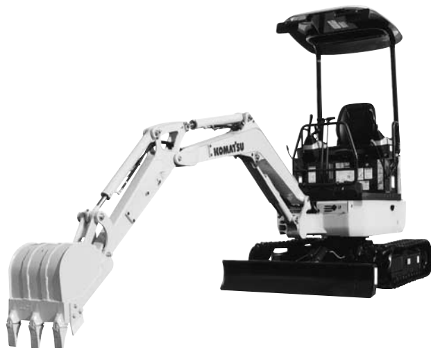
写真一 2 コマツ PC18MR-3 ミニショベル（後方超小旋回形）
