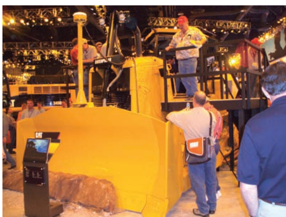
⇧ CAT D7E 電気駆動ブルドーザ
