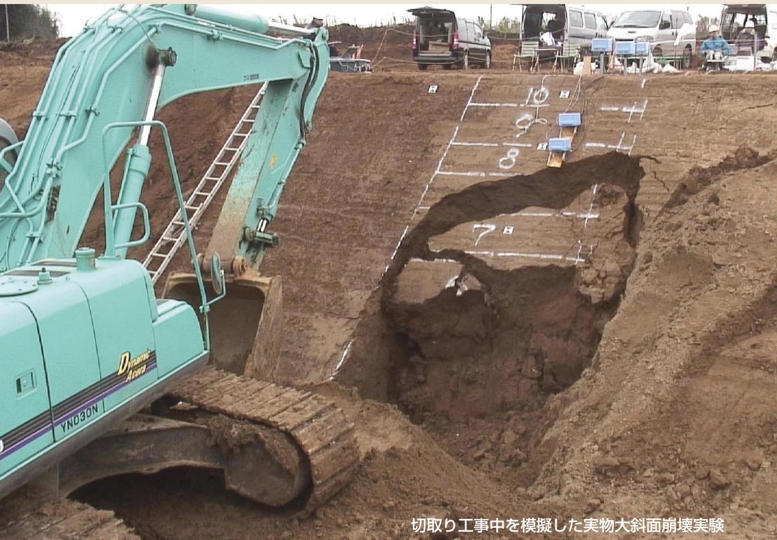
切取り工事中を模擬した実物大斜面崩壊実験
