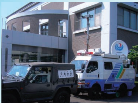
⇧宮城県栗原市花山地区 上流の河道閉塞箇所の映像を受信し、避難場所の石楠花（しゃくなげ）センターのモニターに配信（東北地整 衛星通信車）
