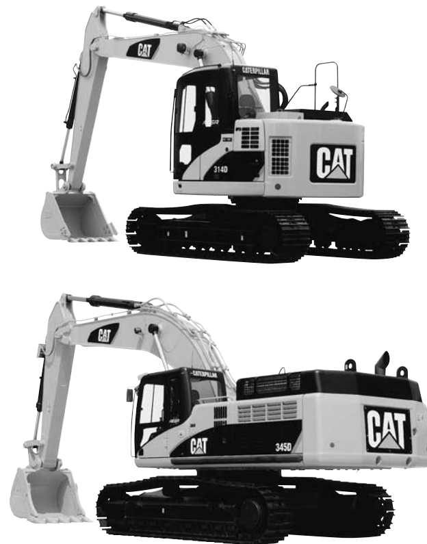
写真一 新キャタピラー三菱「REGA」CAT 314D CR 油圧ショベル (後方超小旋回形) (上) と CAT 345D 油圧ショベル (下)
