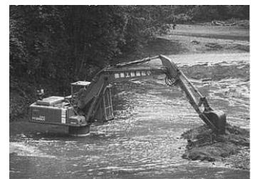
写真—8 水陸両用バックホウ（遠隔操作仕様）
