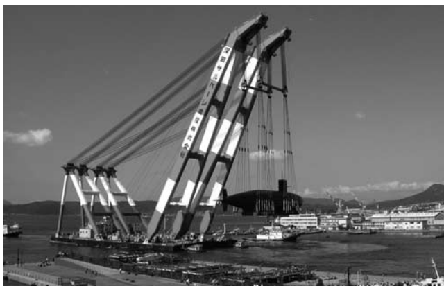
写真—5 潜水艦吊運搬・起重機船係留
