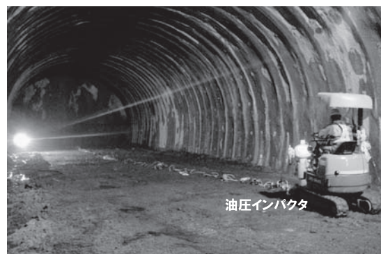
写真—1 トンネル坑内での探査事例 [油圧インパクト震源]
