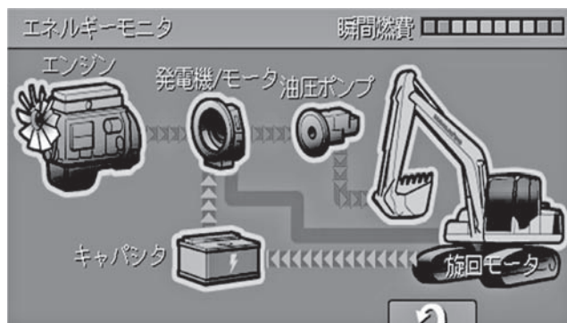
図-12 作業機操作+旋回減速時エネルギーフロー
