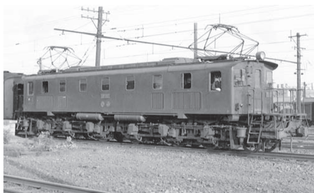
写真—1 中央線 EF11 形直流電気機関車（1934 年製造）
