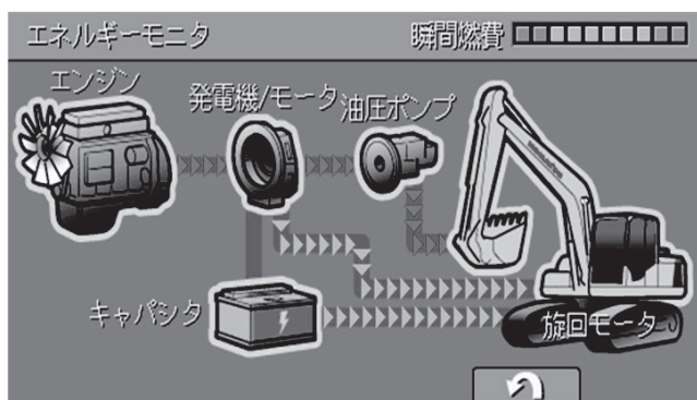
図-11 作業機操作+旋回起動時エネルギーフロー
