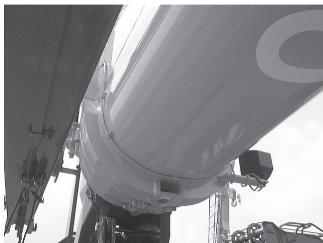
図—2 下面が大きくラウンド（湾曲）したブーム
