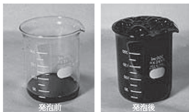
写真—1 フォームドアスファルト発泡状態
