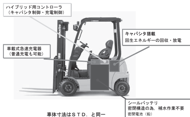
図—2 バッテリーハイブリッド車の構成
