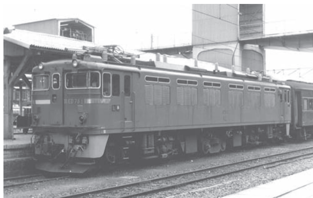
写真—2 ED78 形交流回生ブレーキ付電気機関車（1968 年製造）
