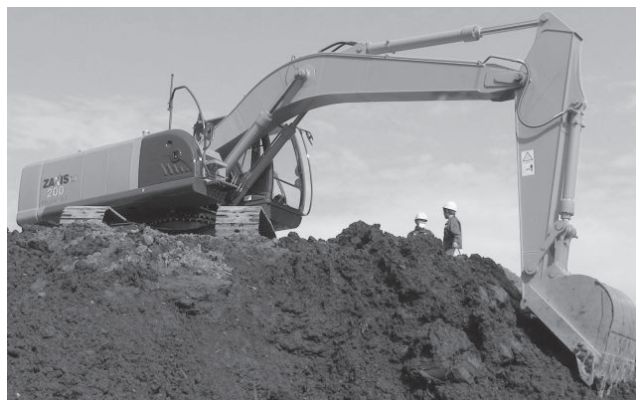
図一11 ハイブリッドショベルの掘削試験状況
