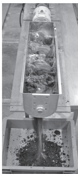
図一2 パドル式混合装置における土砂混合の様子
